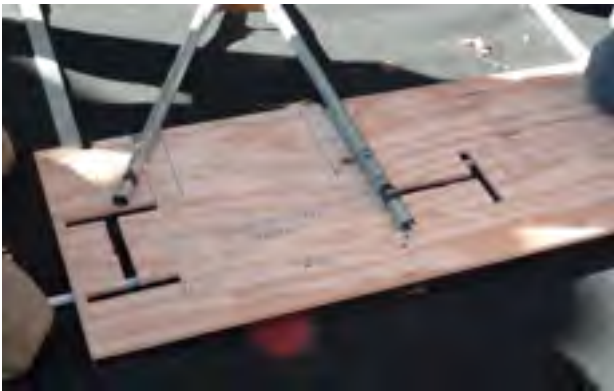
Figure 2.7 Gabarit pour l'implantation des jauges de déformation et gaines pour les câbles
