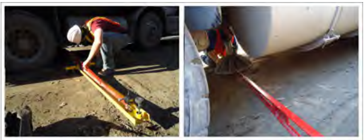
Figure 2.11 Réalisation des essais à la plaque le 13 octobre 2010
