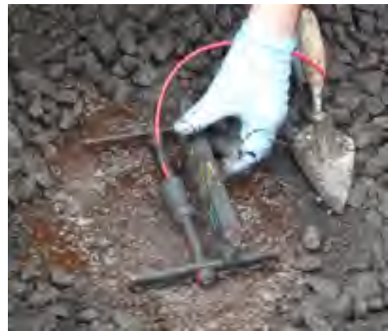
Figure 2.8 Vérification de l'horizontalité de la jauge
