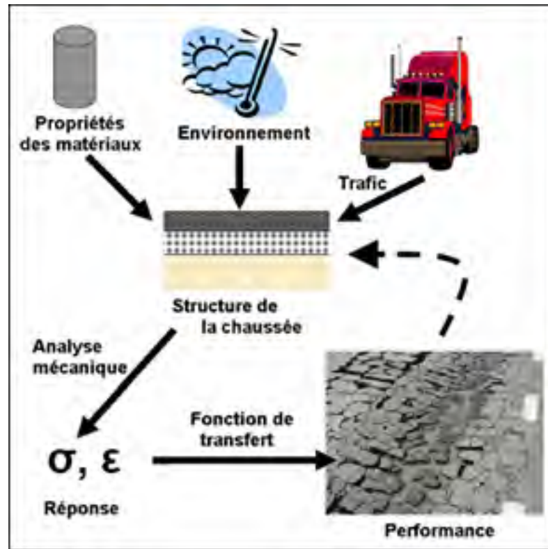
Figure 1.24 Principe de la méthode de dimensionnement mécanistique-empirique Adaptée de Willis et Timm (2009, p. 18)
