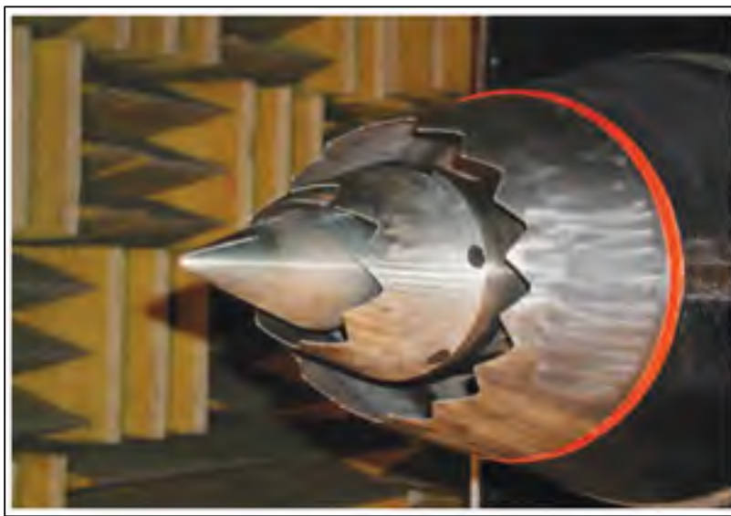
Figure 1.5 Tuyère d'un moteur à réaction possédant des chevrons au niveau du bord de fuite Tirée de Turner et al. (2007)
