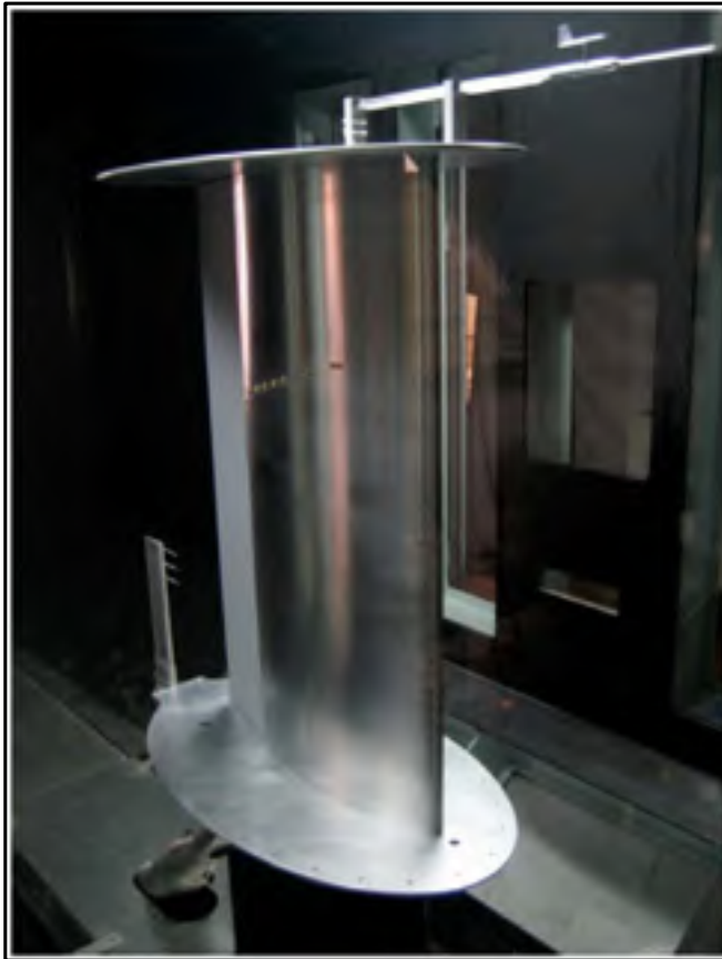
Figure 1.9 Bord de fuite adaptatif à géométrie variable composé d'aluminium Tirée de Hetrick et al. (2007)
