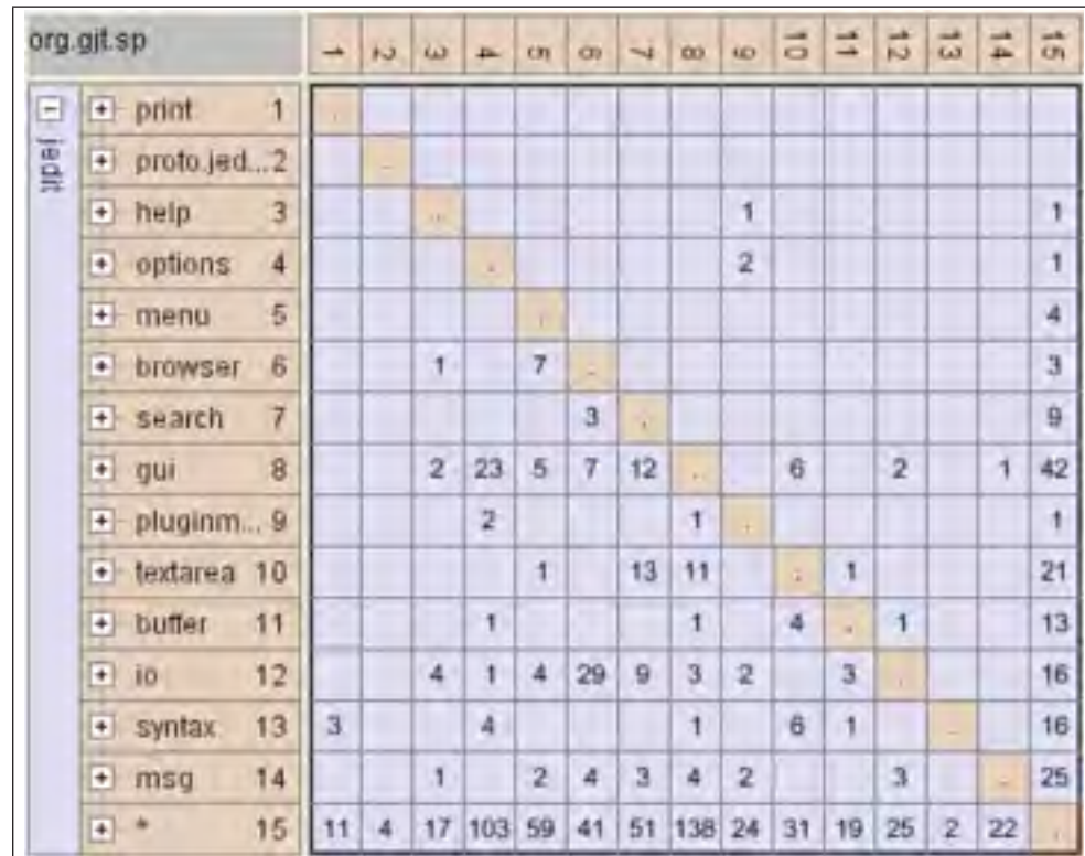
Figure 0.11 Lattix est une visualisation statique montrant les relations entre des modules, de même que leur organisation hiérarchique (Sangal et al. , 2005). Un diagramme à glaçons montre l'indentation de la hiérarchie. Ainsi, print et help sont des modules enfants de jedit .
