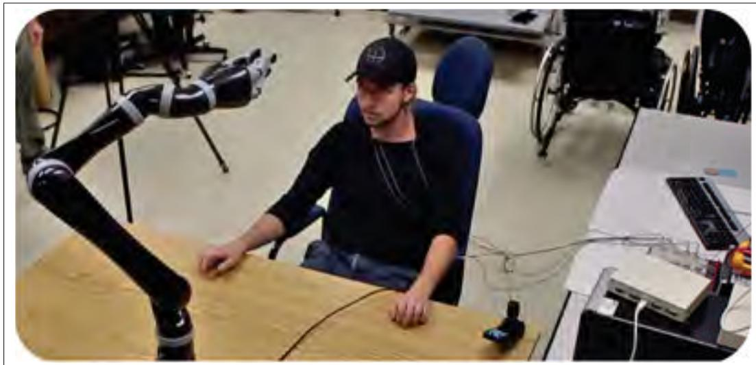
Figure 5.2 Contrôle de Jaco par canaux EMG
