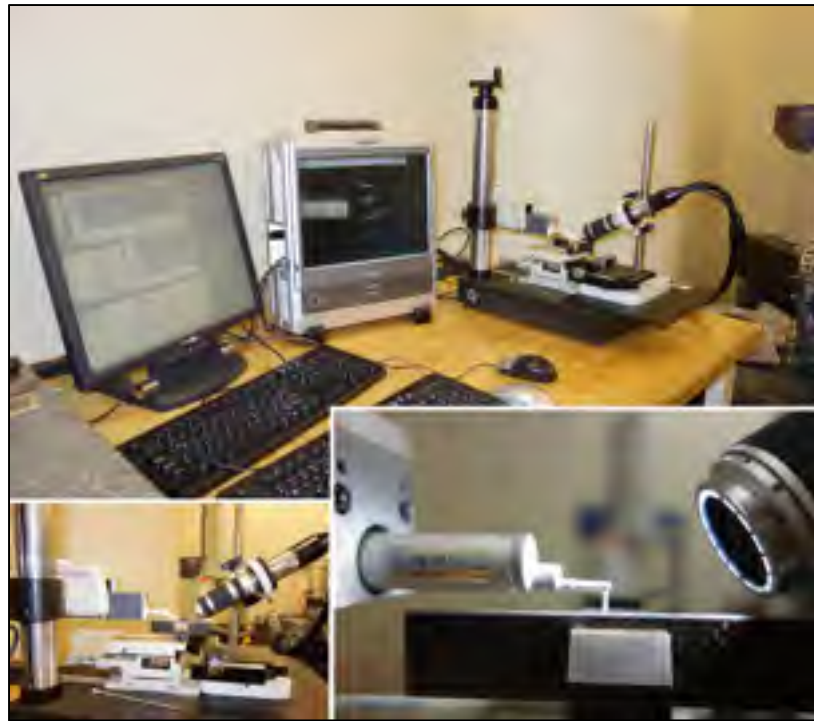
Figure 2.25 Montage pour les mesures de rugosité
