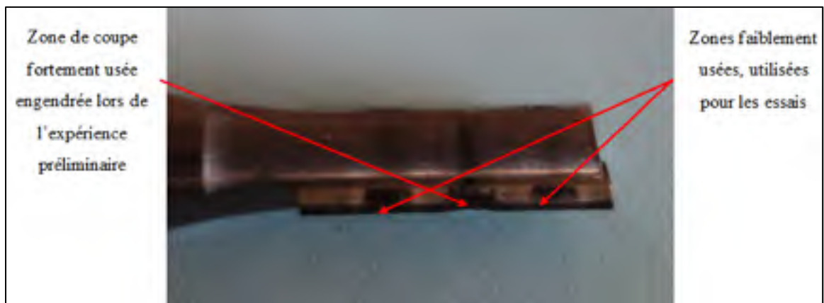
Figure 2.24 Outil de coupe à la fin des essais
