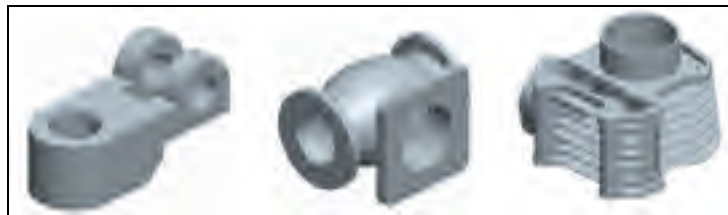
Figure 2-8 Exemples de pièces de fonderies typiques. Tiré de Joshi et Ravi (2010).
