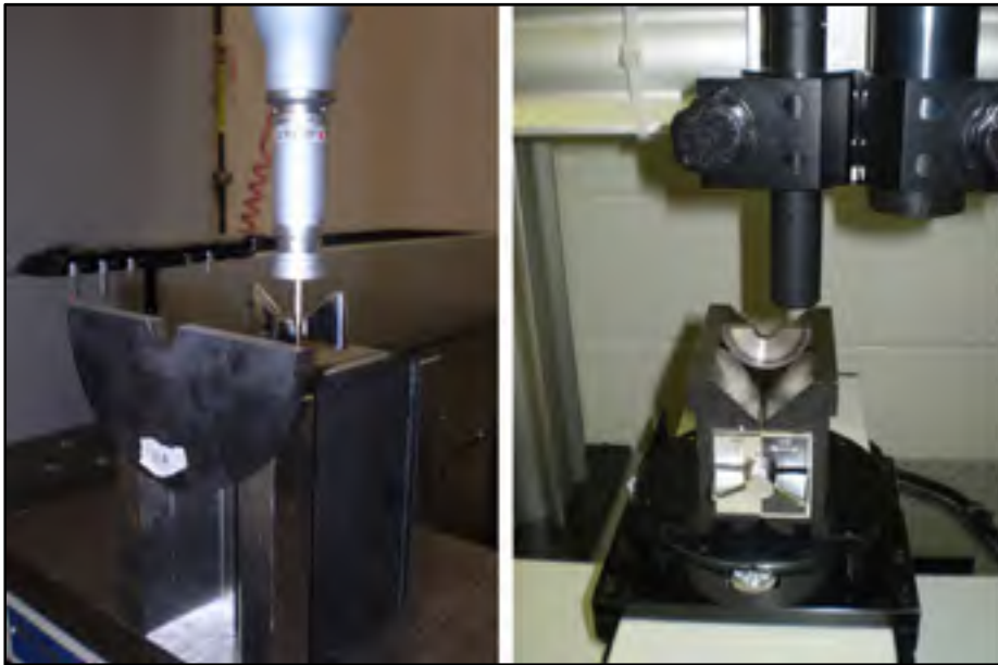
Figure 3.20 Photos de la mesure par MMT (gauche) et par crayon optique confocal (droite)
