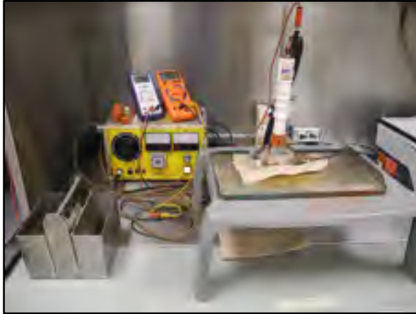
Figure 3.8 Montage utilisé pour l'enlèvement de matière par électropolissage
