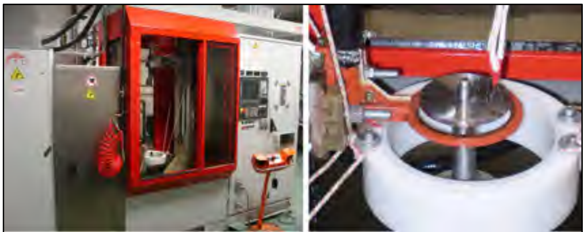
Figure 3.2 Machine à induction de l'ÉTS (gauche) et vue du montage d'un disque (droite)
