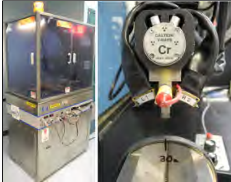
Figure 3.5 Système Proto iXRD® (gauche) et montage pour mesure sur un disque (droite)
