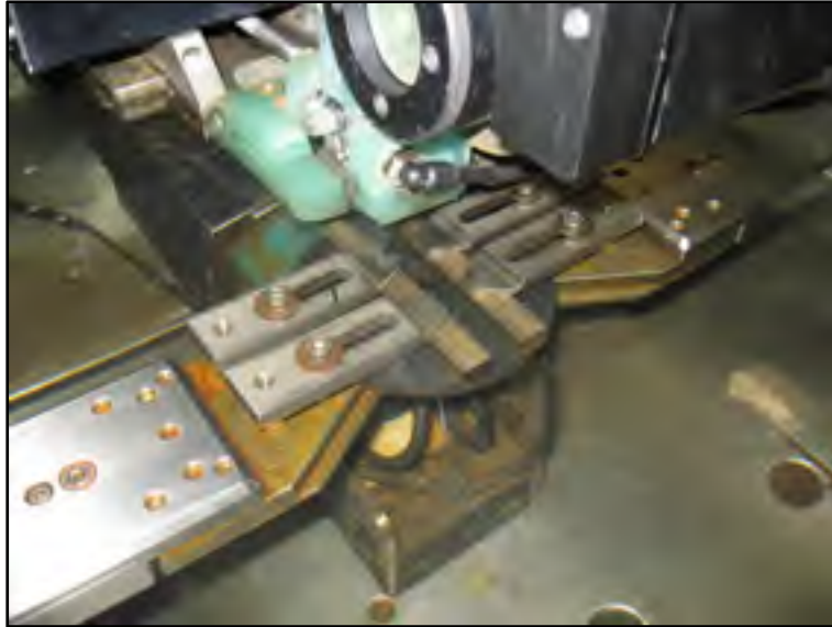
Figure 3.19 Montage pour découpe d'un disque de 106 mm à l'électroérosion à fil sur la machine de PWC
