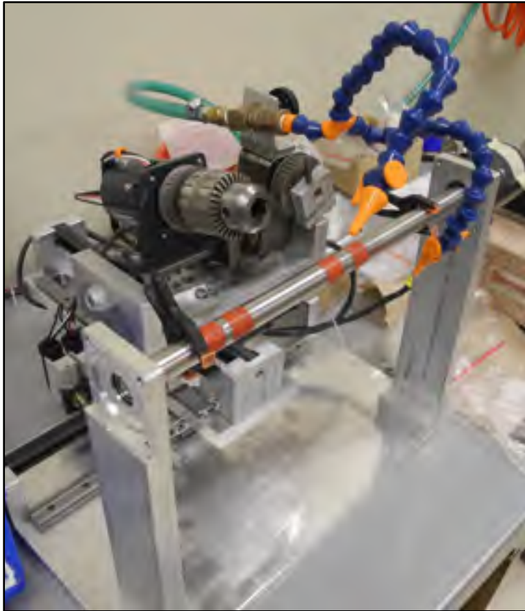
Figure-A XVI-1 Machine de polissage automatique pour les éprouvettes de fatigue
