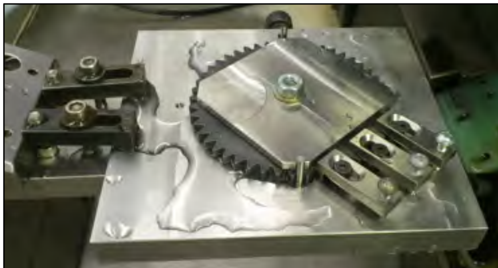
Figure 4.16 Gabarit de coupe pour les roues dentées
