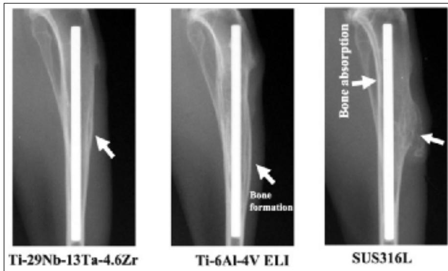
Figure 1.7 Radiographies des tibias de lapin après 24 semaines d'implantation des différents implants métalliques
