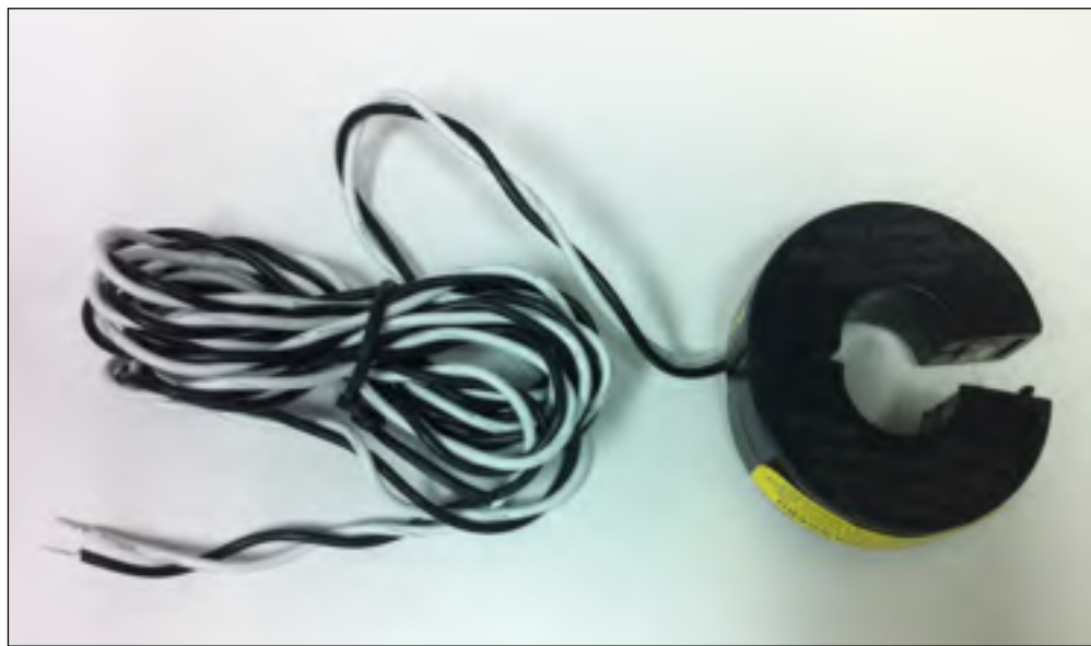
Figure 1.4 Capteur transformateur de courant
