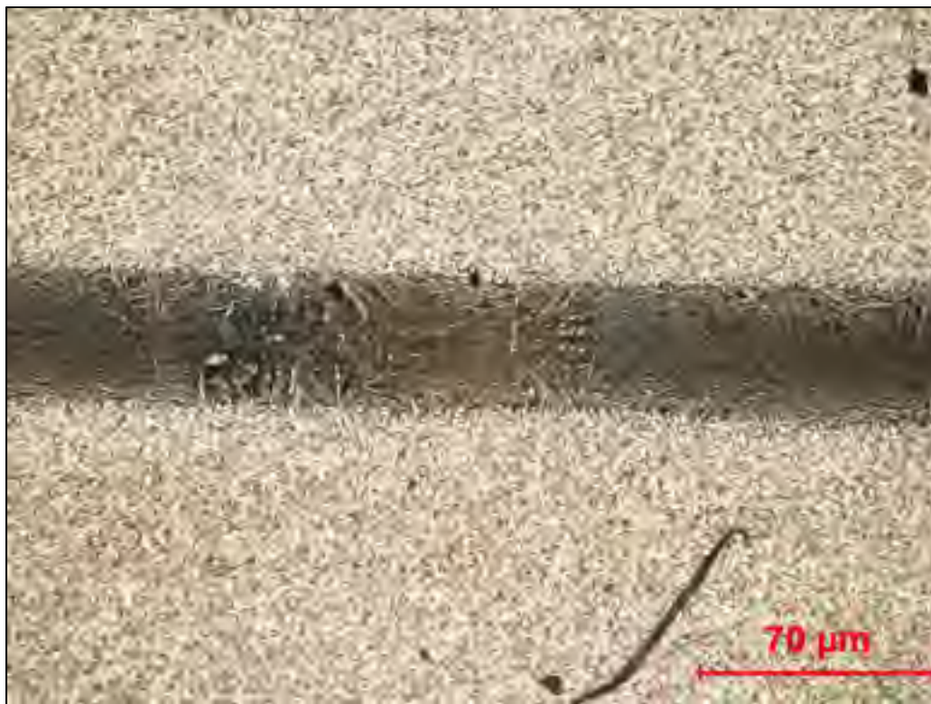
Figure 4.2 Lamelles présentes dans un joint brasé à 900°C pendant 80 minutes
