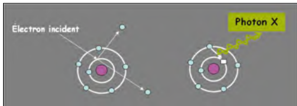
Figure 2.14 Principe de l'analyse par détecteur EDS Tiré de Perrin (2007)
