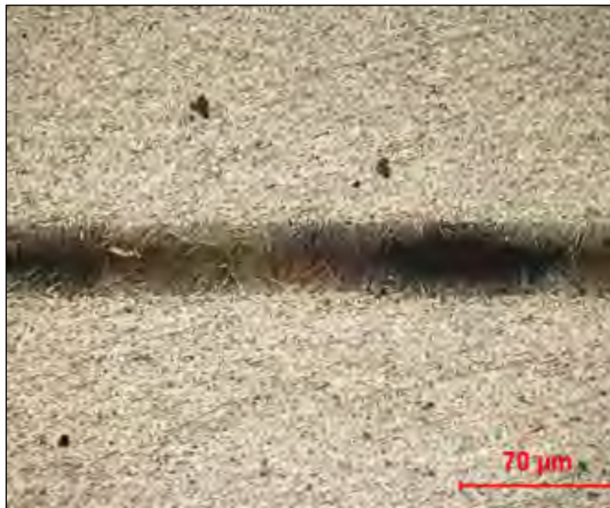
Figure 3.27 Joint à recouvrement brasé à 900°C pendant 40 minutes
