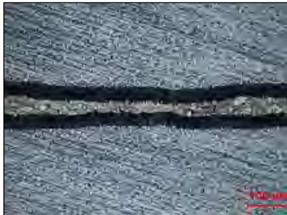
Figure 3.10 Joint brasé à 875°C pendant 20 minutes et de la pâte pour métal d'apport
