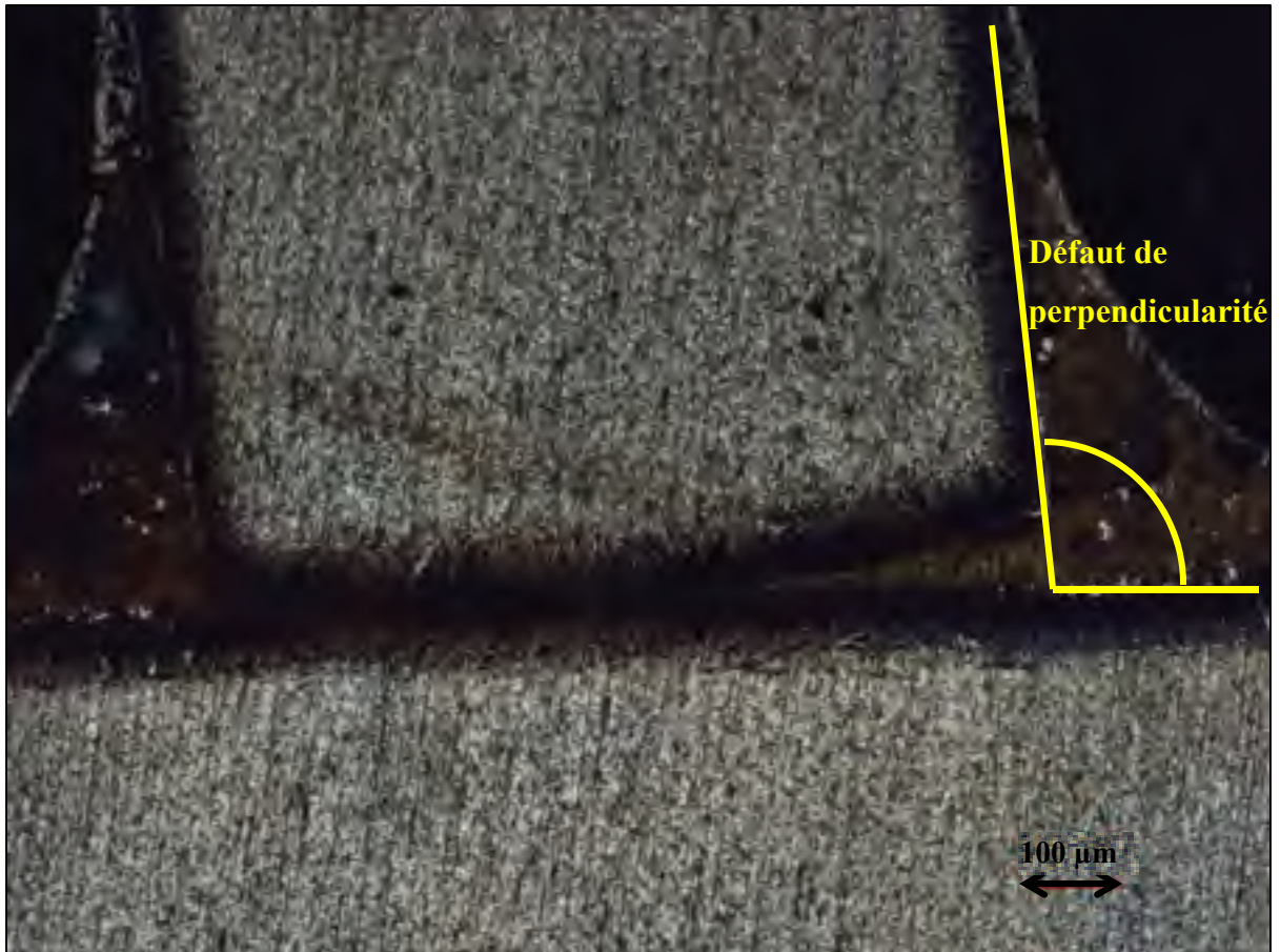
Figure 3.16 Mise en évidence du défaut de perpendicularité sur un joint brasé à 900°C pendant 40 minutes
