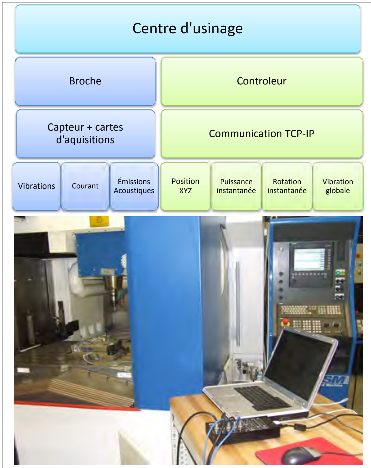
Figure 2. 11 Organisation du système de mesure combiné et localisation des composants
