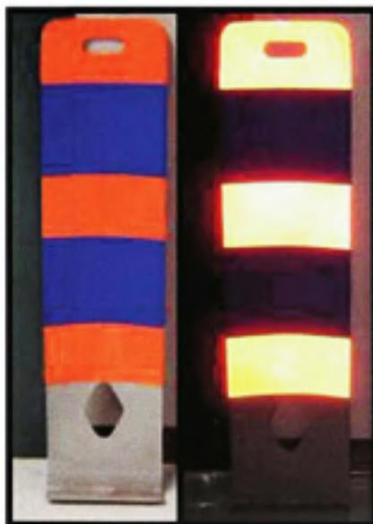
**Figure 3.9** *ÉTS 2 : T-RV-8 modifié en bleu non rétro réfléchissant
