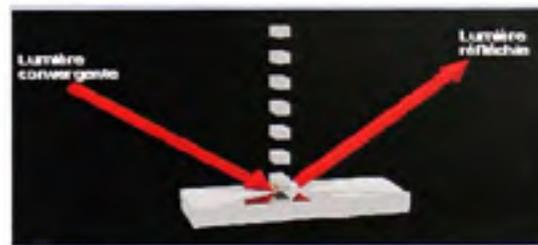
**Figure 1.1 Réflexion spéculaire.**
