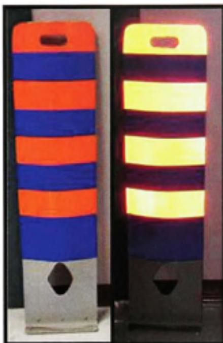
**Figure 3.8** *ÉTS 1 : T-RV-8 modifié en bleu non rétro réfléchissant
