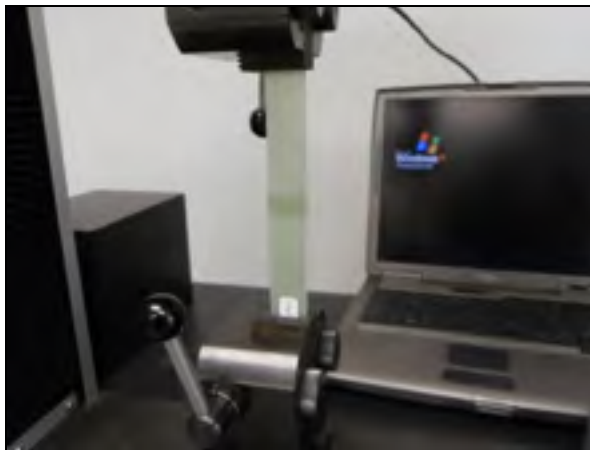
Figure 3.13 Montage d'essais de cisaillement adhésif en tension
