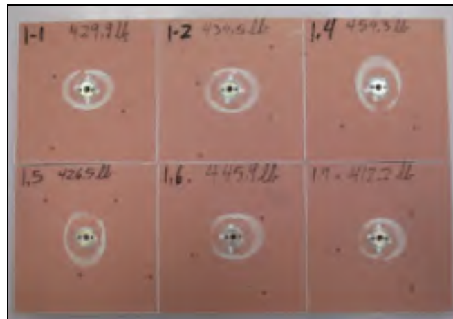
Figure 3.27 Essais d'arrachement des inserts sur noyaux en mousse (C70.90)
