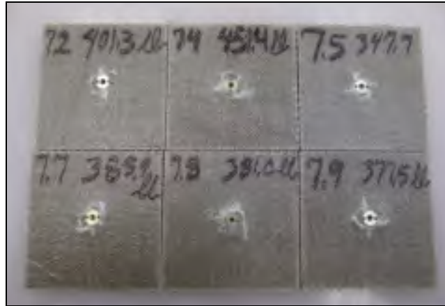
Figure 3.26 Essais d'arrachement des inserts sur les noyaux en nid d'abeille (PN2)
