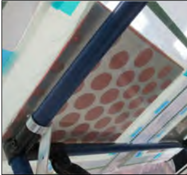
Figure 3.31 Comportement du front de résine, vue du dessous
