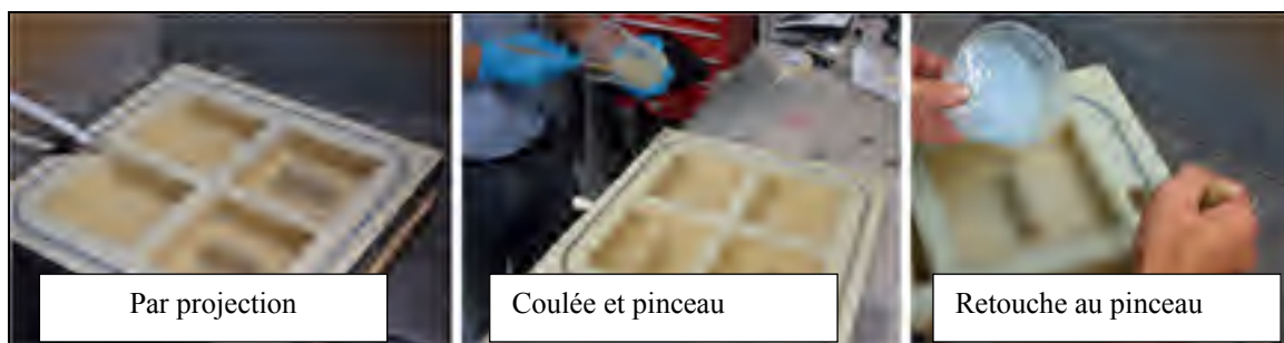
Figure 3.5 Moule de torture, fabrication des membranes
