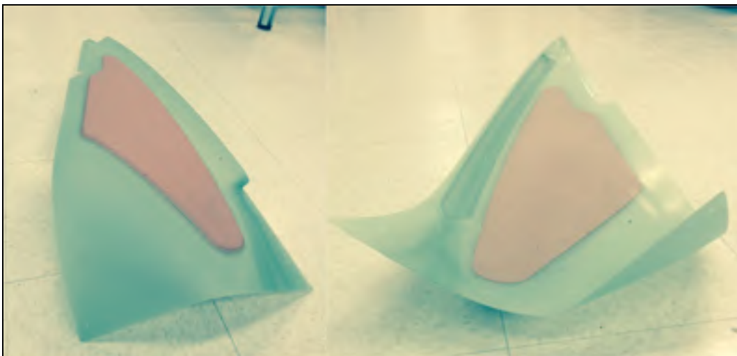
Figure 3.30 Pièce typique avec un noyau en mousse
