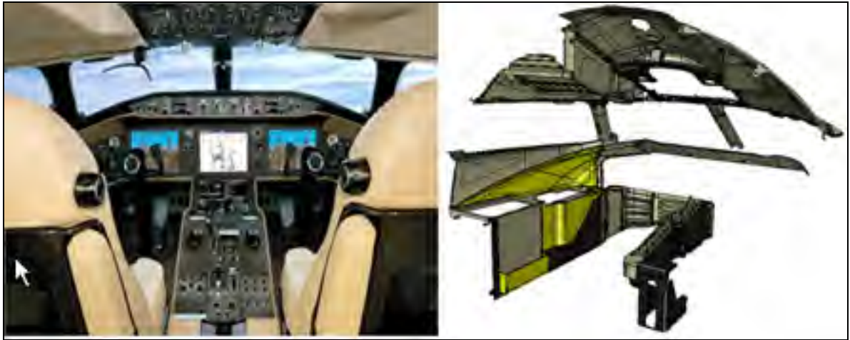
Figure 2.1 Panneaux d'habillage du cockpit du Global Express
