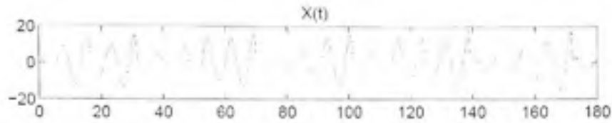
Figure 3.3 Décours temporel de la composante x(t) d'un oscillateur de Rossler.
