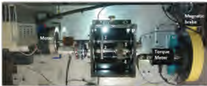
FIGURE 5.2 – Le banc d'engrenages Spectra-Quest après les modifications.
