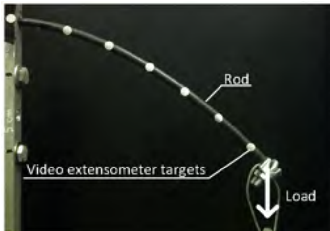
Figure 1.18 Photographie d'un test de flexion encastrée
