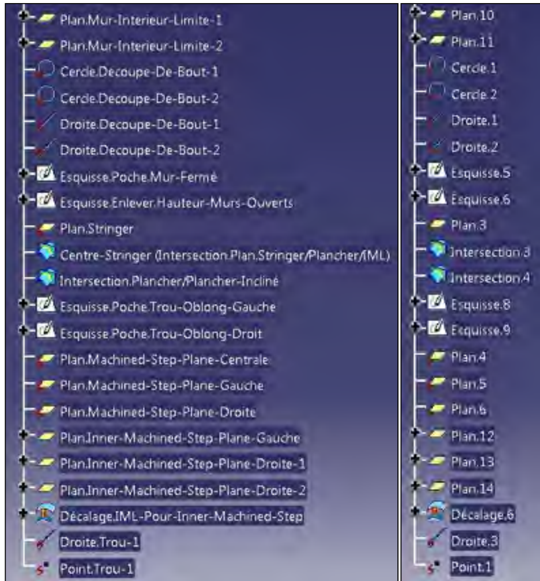
Figure 2.17 Arbre de construction du modèle renommé et du modèle non renommé (Set Géométrique suite)
