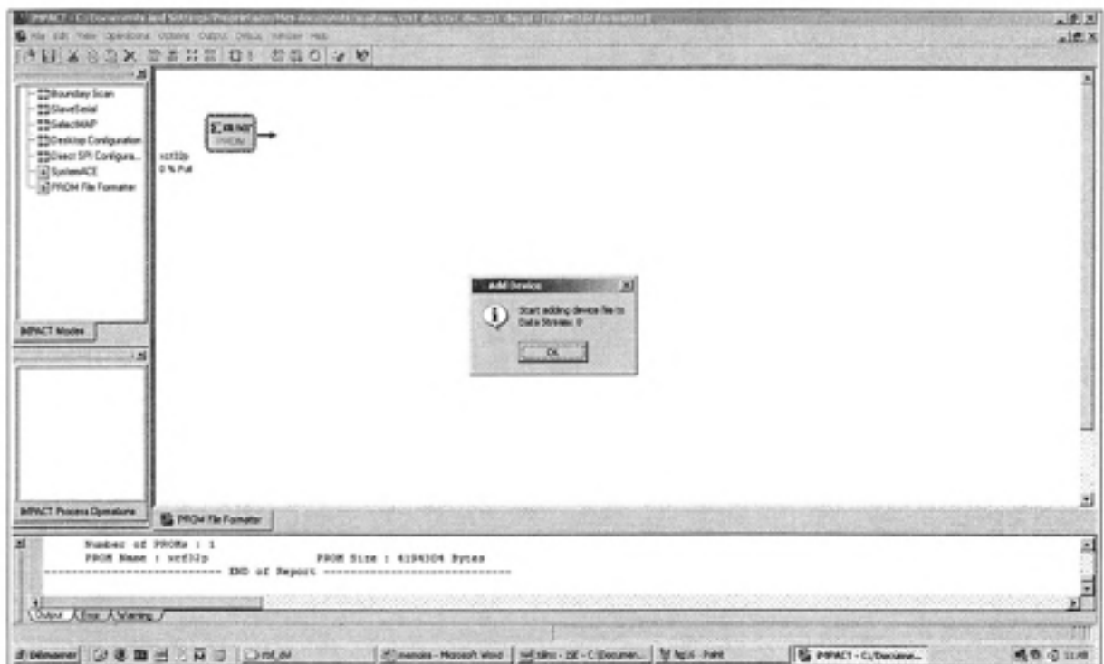
Figure 7.16 Fenêtre de sélection des fichiers de configuration du FPGA du logiciel iMPACT.
