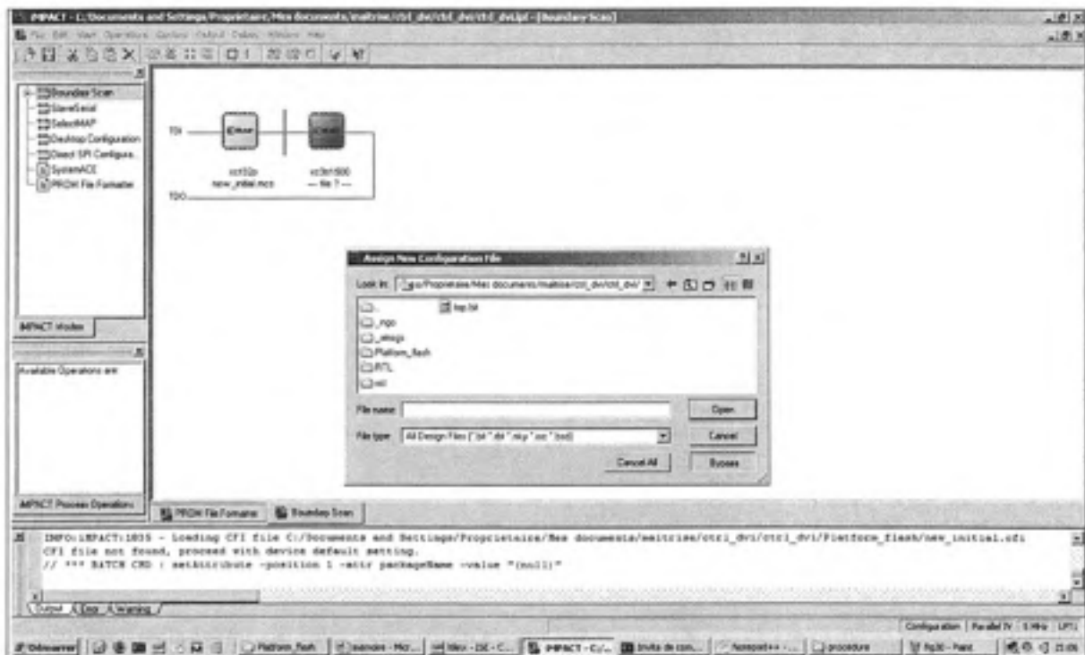
Figure 7.29 Fenêtre de dialogue pour désactiver la programmation du FPGA avec le logiciel iMPACT.
