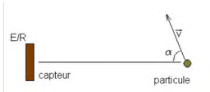
Figure 2.1 Principe d'émission des ondes par l'ADCP
