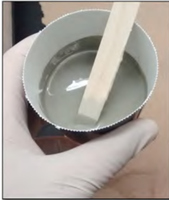
Figure 2.11 Mélange de SiC, résine et durcisseur
