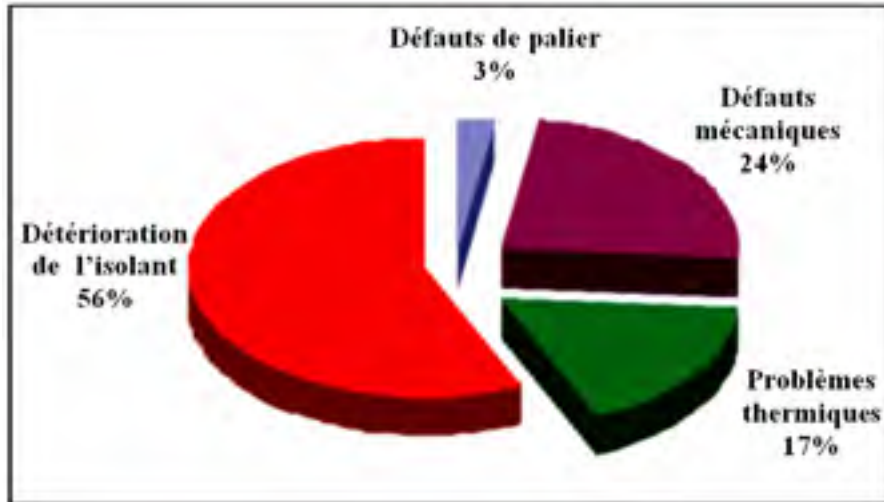
Figure 1.1 Les défauts majeurs des hydro générateurs Tirée de Rusu-Zagar, Notingher et Stancu (2014)
