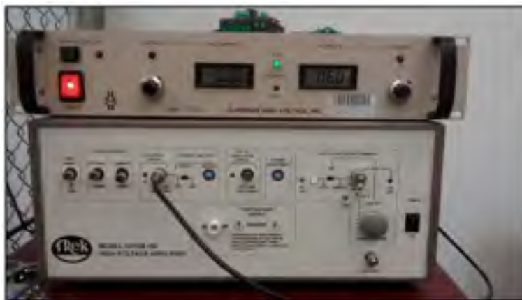
Figure 2.8 Source de haute tension GLASSMAN (appareil du haut)
