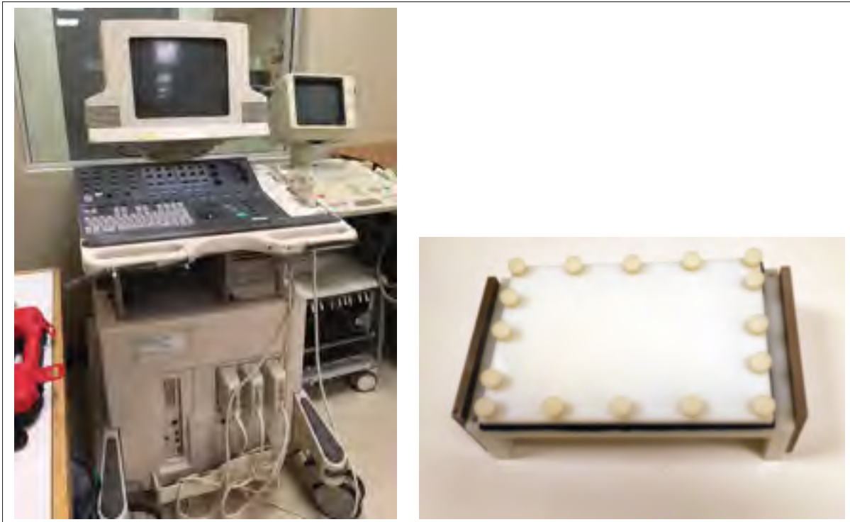
Figure 3.1 Images de l'échographe (gauche) et du fantôme de speckle (droite)
