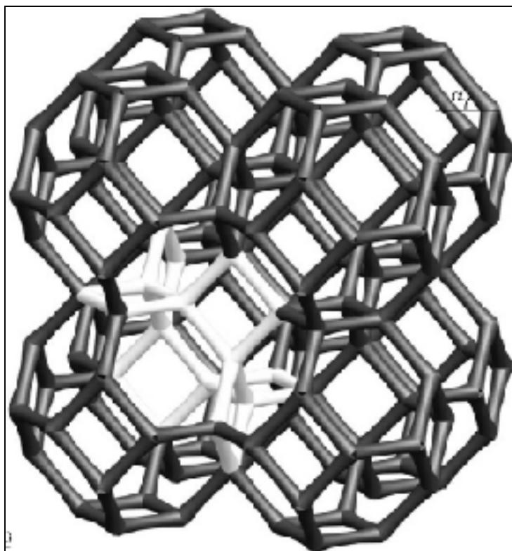
Figure 1.9 Structure poreuse ordonnée fondée sur la répétition de cellules unitaires de tétrakaidécaèdre
