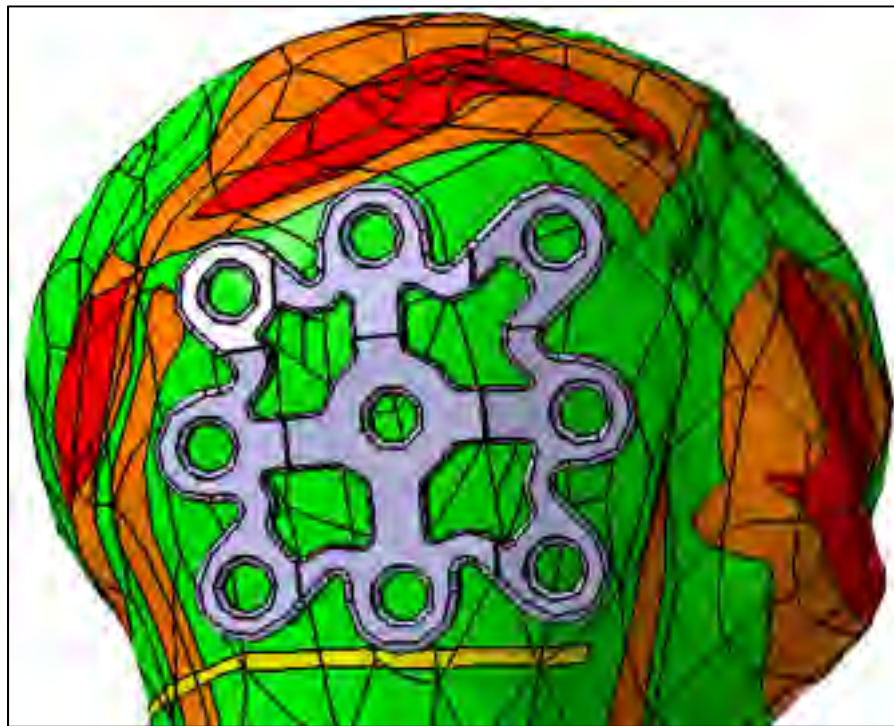
Figure 4.13 Concept final de plaque d'ostéosynthèse de la GT
