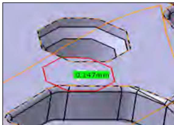
Figure-A VIII-5 Mesure du déplacement nécessaire pour la branche centrale-médiale
