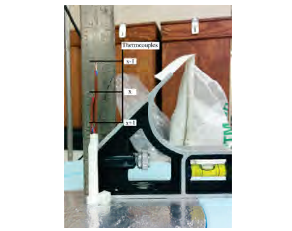
Figure 3.9 Photo des trois thermocouples
