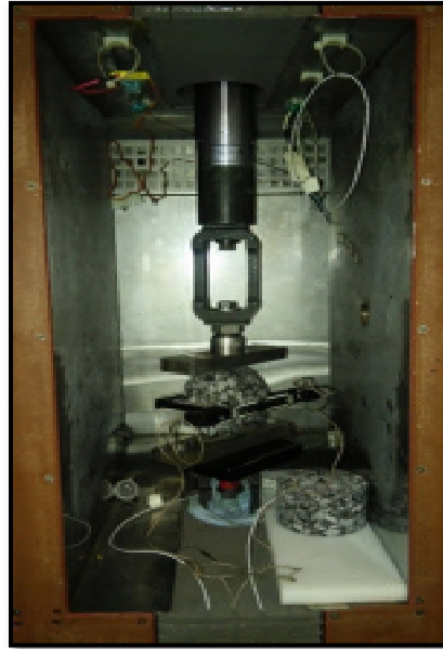
Figure 3.10 Illustration d'une éprouvette montée dans la presse pour un essai de module de rigidité
