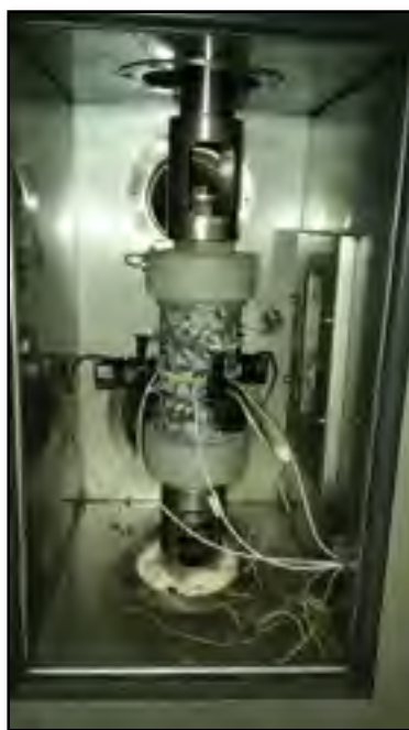
Figure 3.8 Illustration d'une éprouvette montée dans la presse pour un essai de module complexe
