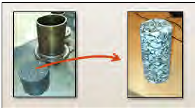
Figure 3.3 Briquette de 150mm compactée à la PCG et éprouvette de 75mm de diamètre extraite par carottage
