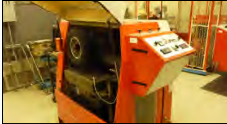
Figure 3.6 Ornièreur LCPC du LCMB
