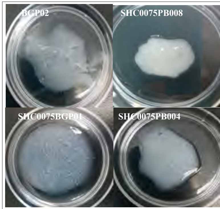
Figure 3.4: Injection de gels sur une surface à 37C
