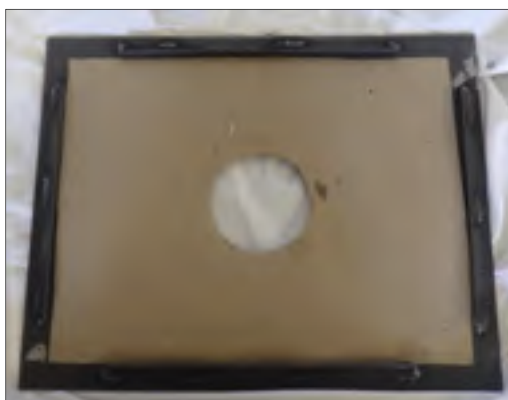
Figure 2.4 Fond percé du moule recouvert de parement
