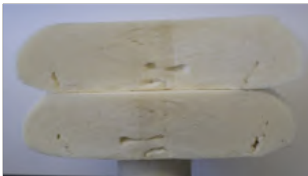
Figure 2.14 Coupe intérieure de l'échantillon n°2 de la deuxième stratégie
