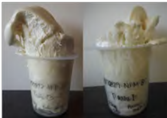
Figure 2.28 Comparaison entre la perte de matière causée par un temps de mélange trop long (gauche) et un temps de mélange optimisé (droite)
