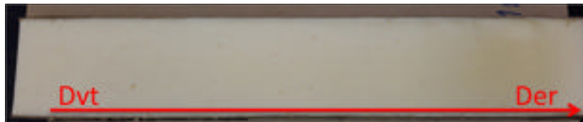
Figure 2.32 Inhomogénéité à la fin de la mousse
