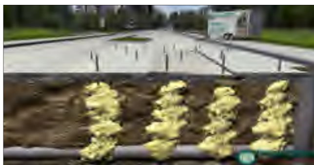
Figure 1.16 Illustration du polyuréthane injecté pour la stabilisation du sol
