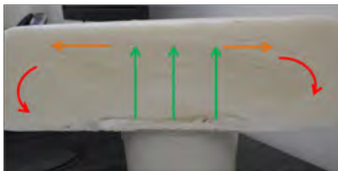
Figure 2.17 Évolution du front de gonflement de la mousse lors de la procédure n°2
