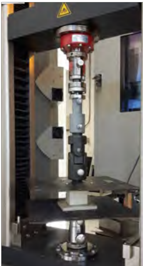
Figure 2.40 Essai de traction d'un spécimen de polyuréthane
