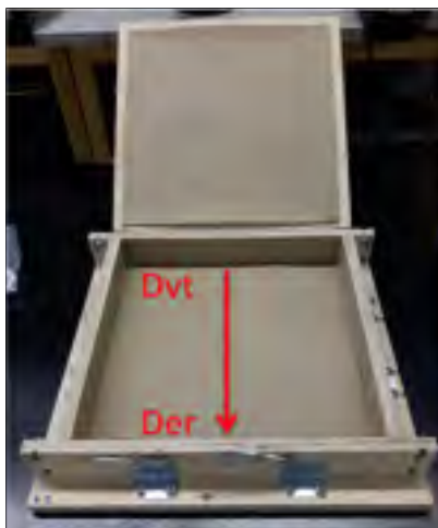
Figure 2.31 Sens de versement du mélange dans le moule
