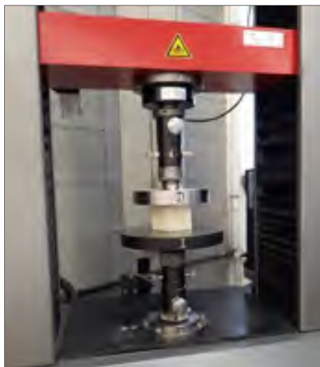
Figure 2.37 Essai de compression sur un spécimen de polyuréthane
