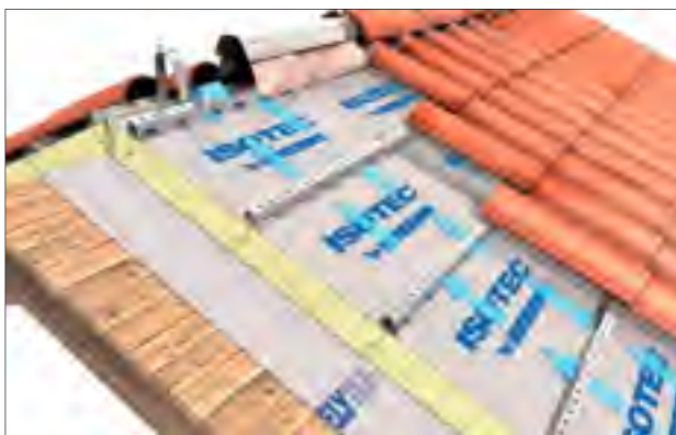
Figure 1.19 Exemple d'isolation d'une toiture à l'aide de panneaux en PU Tirée de (Plastica, 2016)
