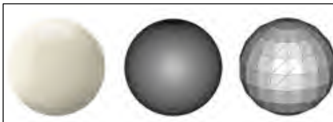
Figure 3-12 Facettes triangulées d'une sphère Tirée de https://i.materialise.com/ , le 5 juin 2017
