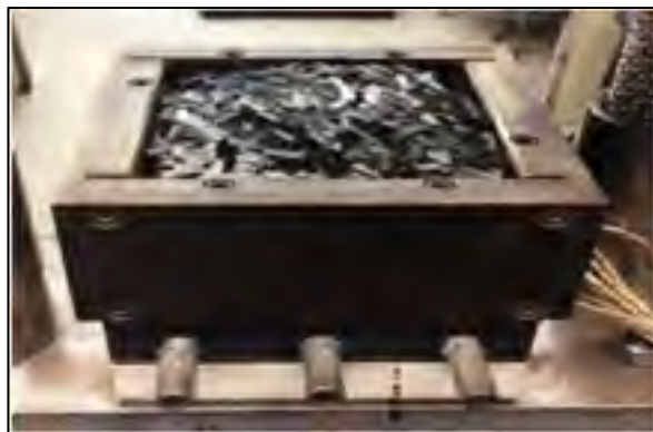
Figure 1.2 La cavité de la pièce en forme T remplie de brins tirés de Wazziki (2015, p.2)
