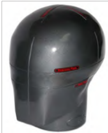
Figure 1.27 Forme de tête selon les requis de EN 960 Tirée de (Cadex Inc., 2017)
