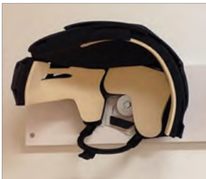
Figure 1.4 Casque de hockey coupé en deux Adaptée de (TuxBoard, 2011)
