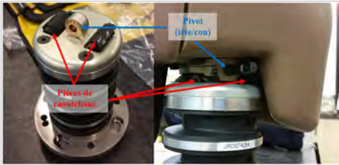
Figure 7.3 Cou H350 - Pièces de caoutchouc et axe de pivot
