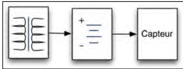
Figure 2.3 Capteur alimenté par batterie et rechargé par induction électromagnétique
