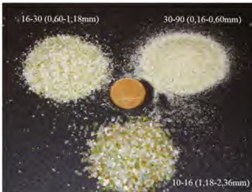
Figure 3.1 Trois différents types de classe granulaire de verre recyclé mixte utilisés dans ce projet
