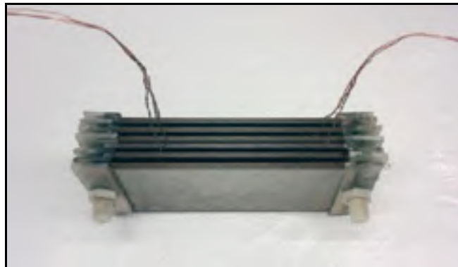
Figure 2.1 : Montage expérimental des électrodes en acier
