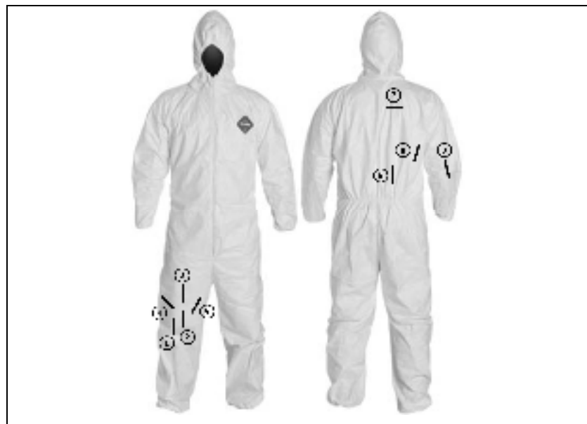
Figure 3-3 : Positionnement des capteurs sur les combinaisons
