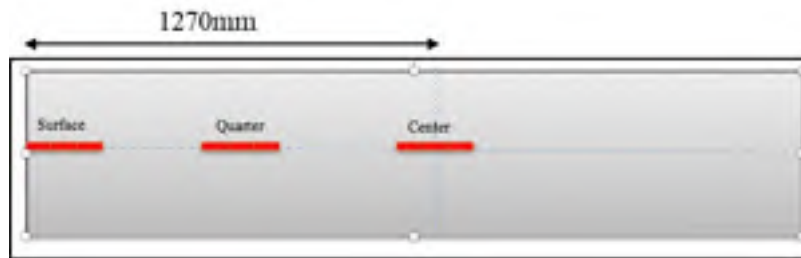
Figure 2.10 Éprouvettes prises à différentes places (surface, quart et cœur) du bloc d'acier étudié
