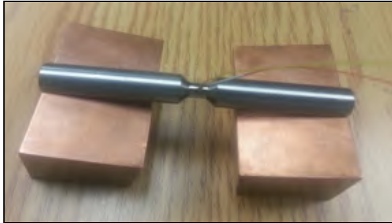
Figure 2.9 Disposition des mors et des thermocouples autour de l'échantillon (Ben Fredj, et al 2017).
