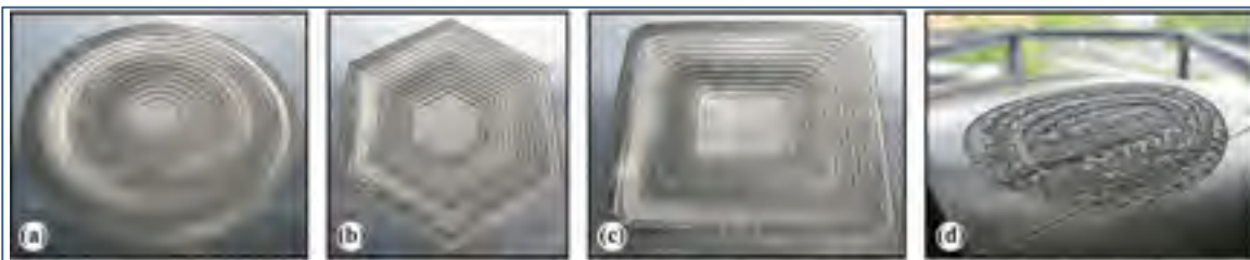
Figure 1.36 : Géométries possibles pour les réparations en escalier avec préparation de surface laser (Sunar et Kaden, 2012)
