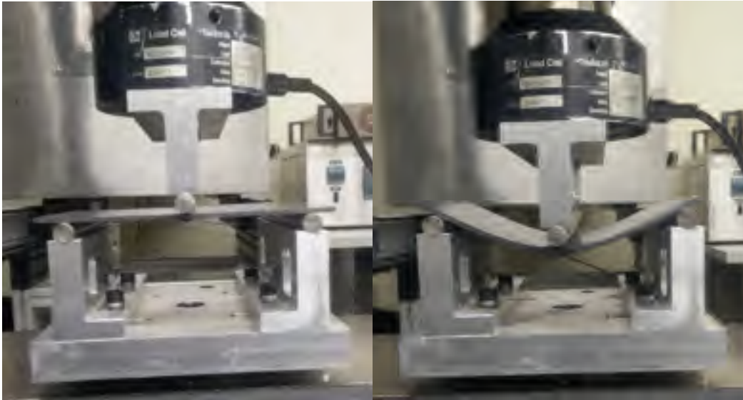
Figure 3.10 : Plaque de CF/PEEK endommagée par DTI lors d'un essai de flexion en trois points.
