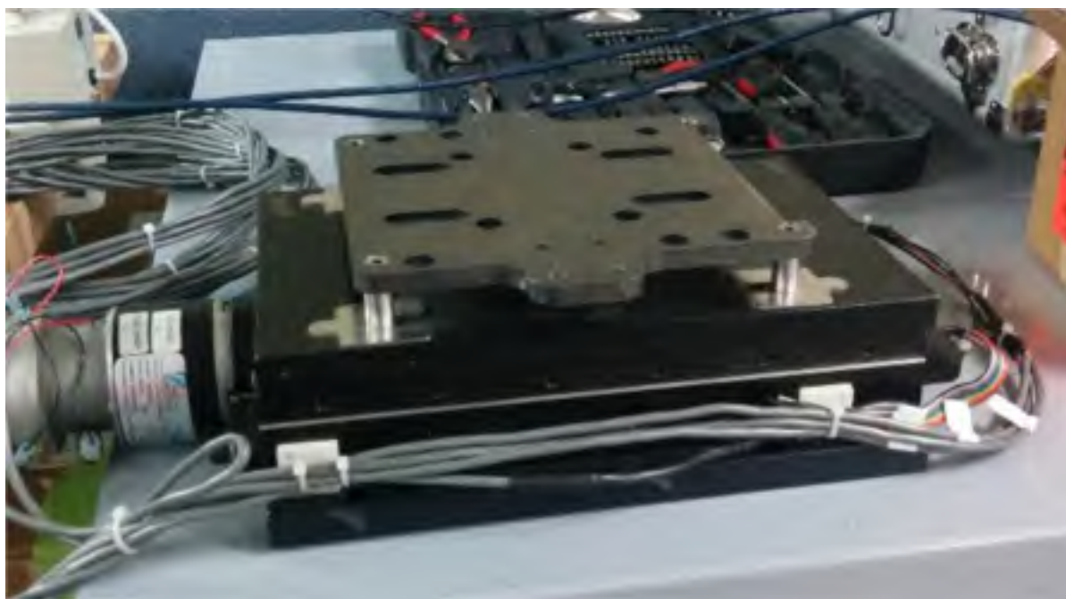
Figure 2.6 : Table à motion linéaire Pacific Scientific
