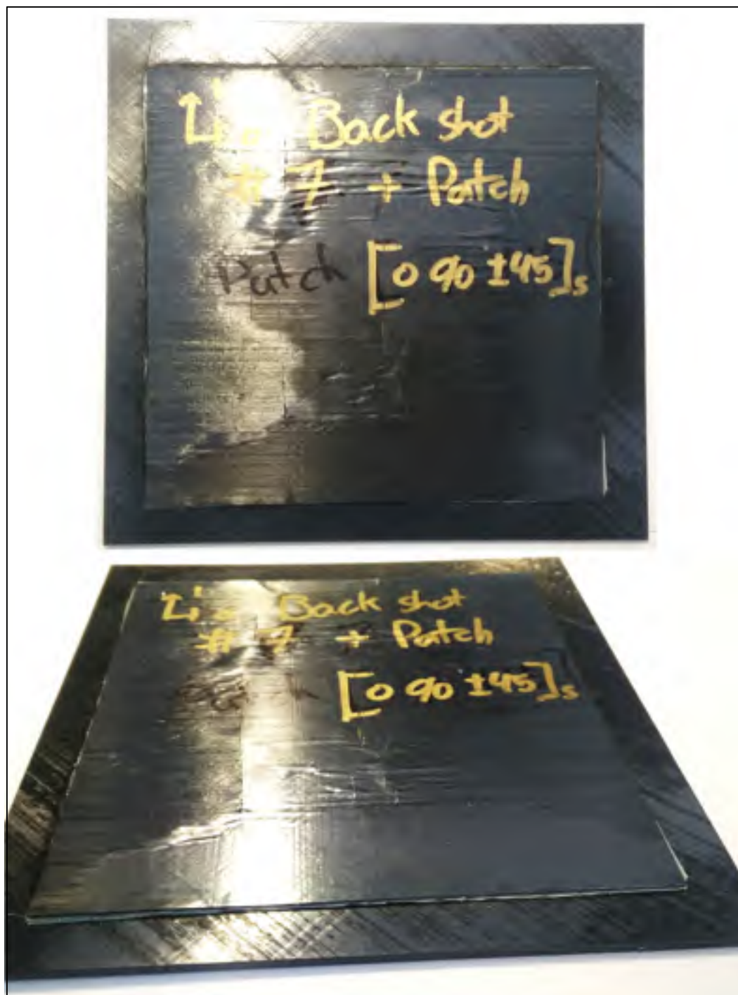
Figure 3.13 : Photos de la réparation sur la plaque MCG7 arrière suite à un essai de flexion trois points.
