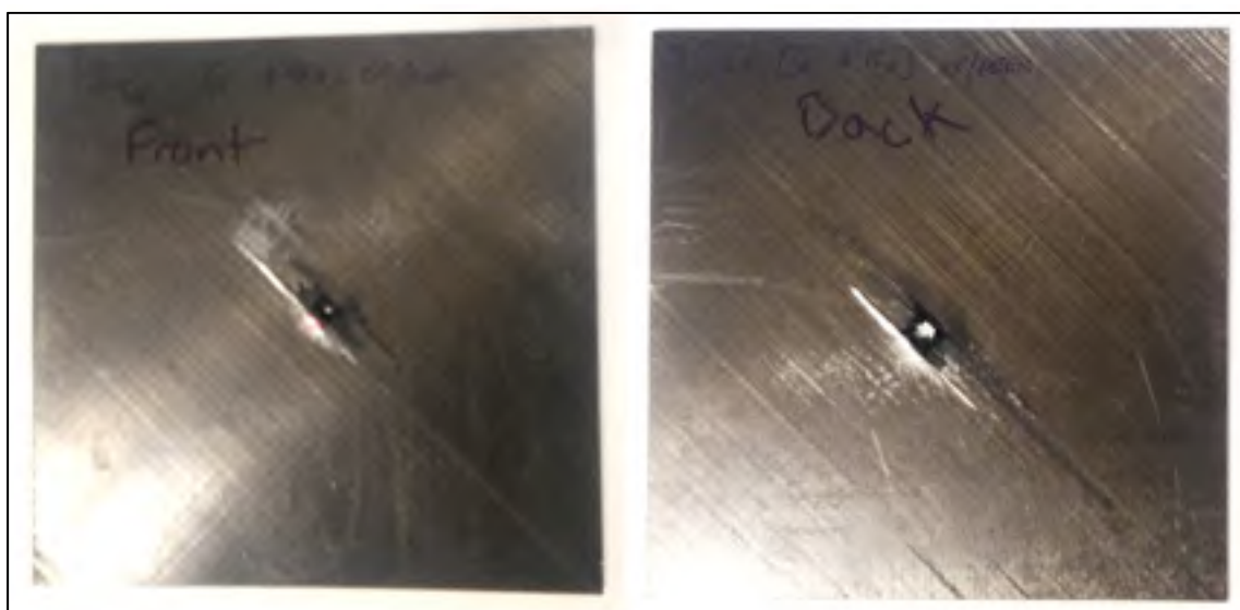
Figure 3.5 : Endommagement suite à un impact balistique double; à gauche l'endommagement sur la face avant; à droite l'endommagement sur la face arrière
