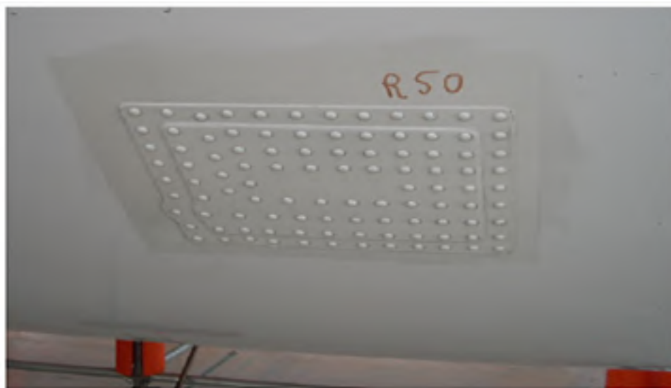
Figure 1.34 : Réparation par patch riveté sur un fuselage (Hautier, 2010)
