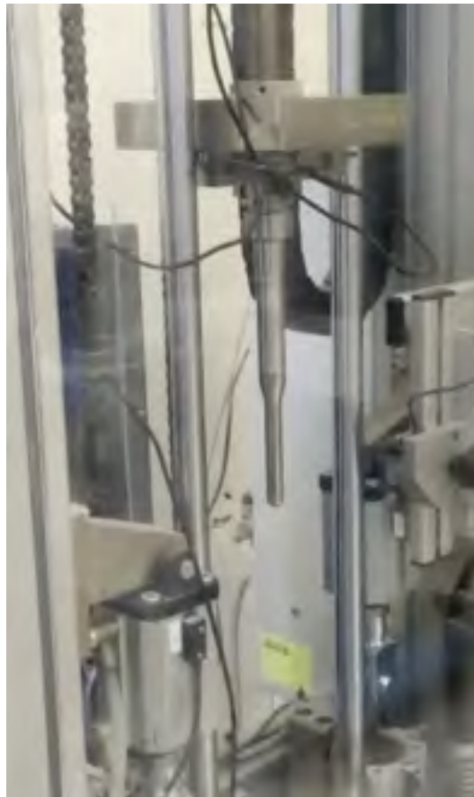
Figure 2.4 : Impacteur de ½ po utilisé pour les impacts DTI
