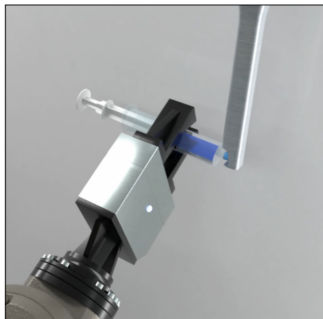
Figure 2.23 Modélisation de la phase de bouchonnage
