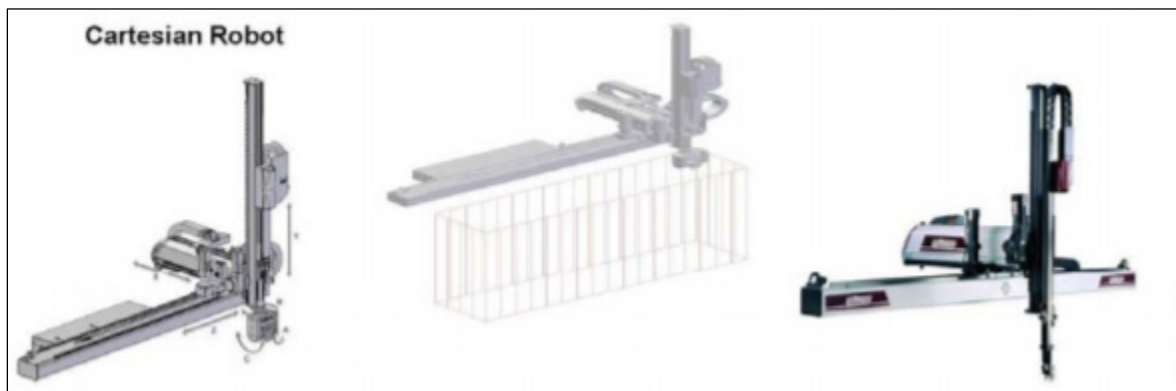
Figure 2.3 Robot de type cartésien Tirée de IFR (2016)
