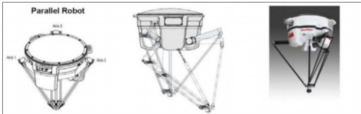
Figure 2.2 Robot parallèle de type Delta Tirée de IFR (2016)
