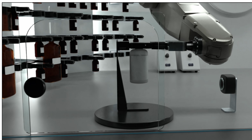
Figure 2.36 Modélisation du positionnement de la zone d'échange de bouteilles entre le préhenseur et le technicien
