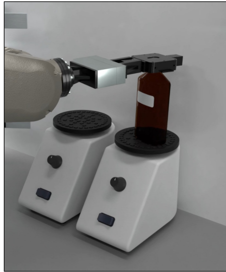
Figure 2.35 Modélisation du positionnement de la bouteille sur le mélangeur
