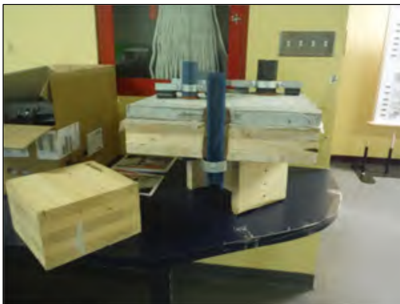
Figure 4.10 Prototype du complexe plancher bois-béton
