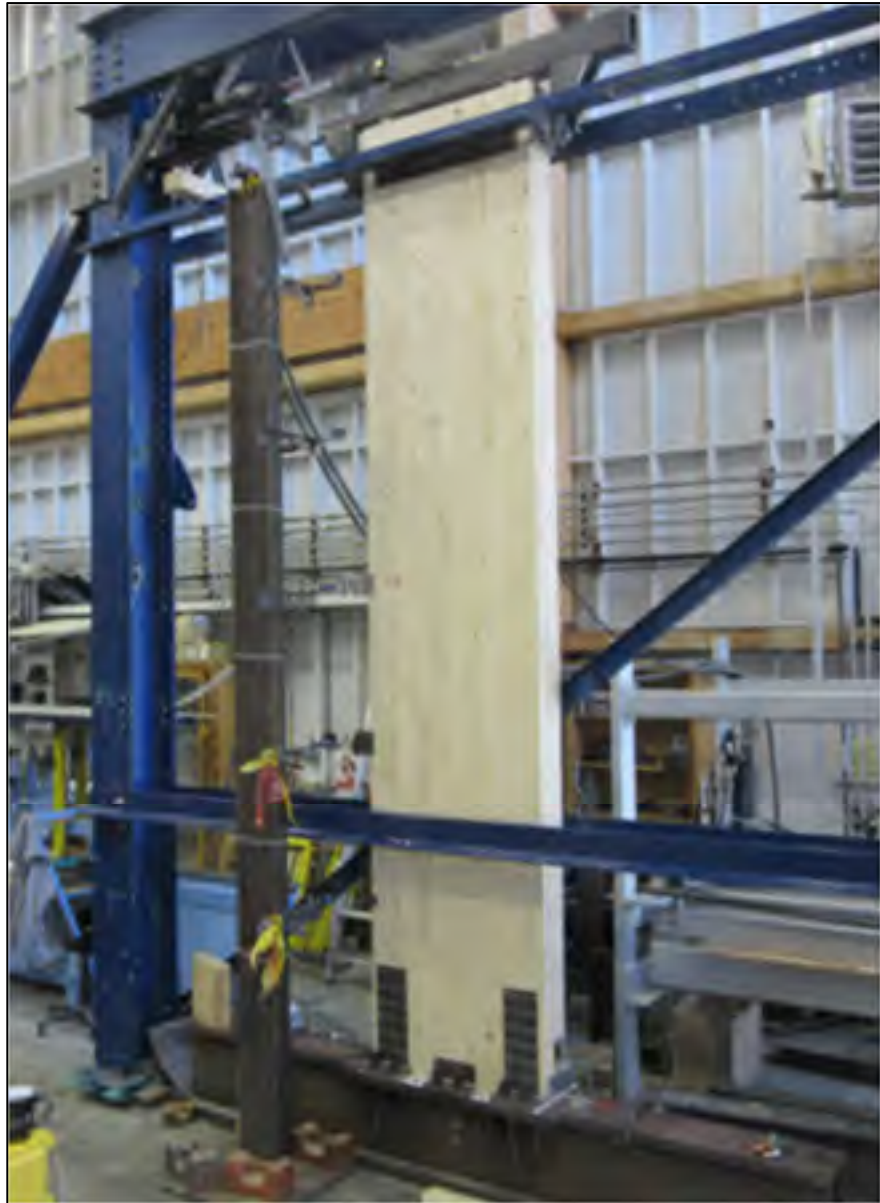
Figure 4.6 Mur de refend mis à l'essai en laboratoire chez FPI Tirée de CECOBOIS et FPI (2018)
