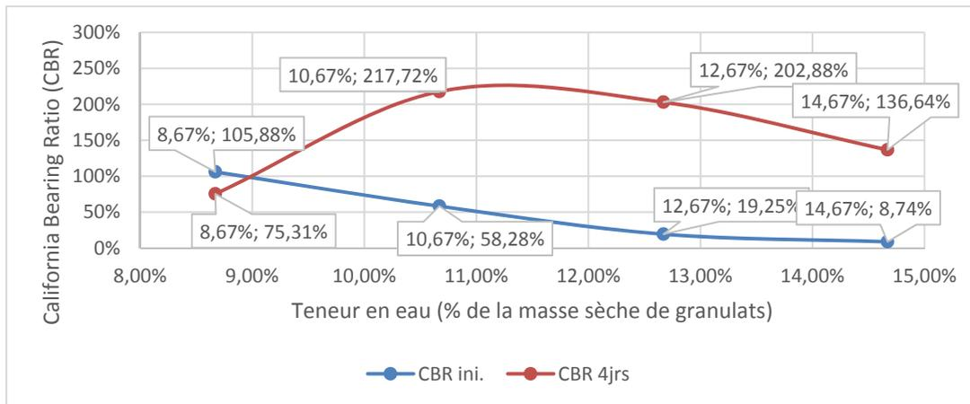
Figure 4.15 Évolution du California Bearing Ratio initial et à 4 jours d'immersion selon la teneur en eau – Conception à 5% de ciment
