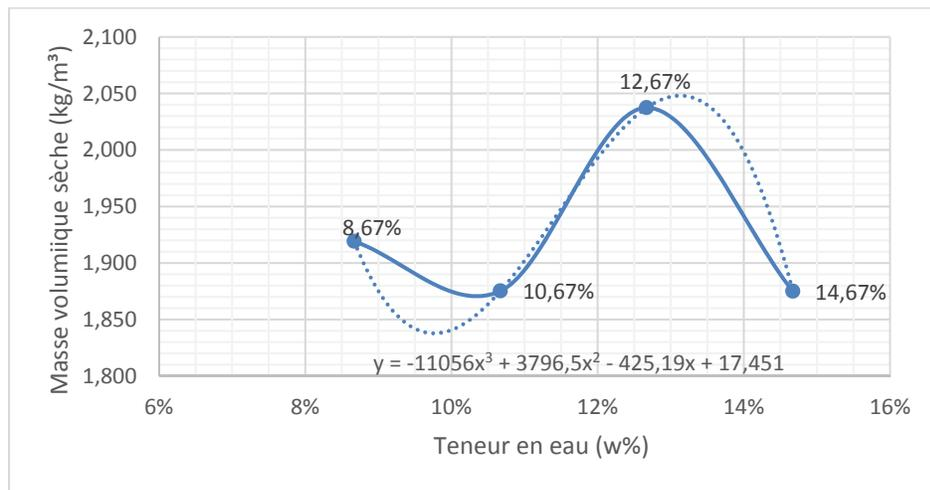
Figure 4.35 Relation teneur en eau et masse volumique sèche – Mélanges à 7% de ciment
