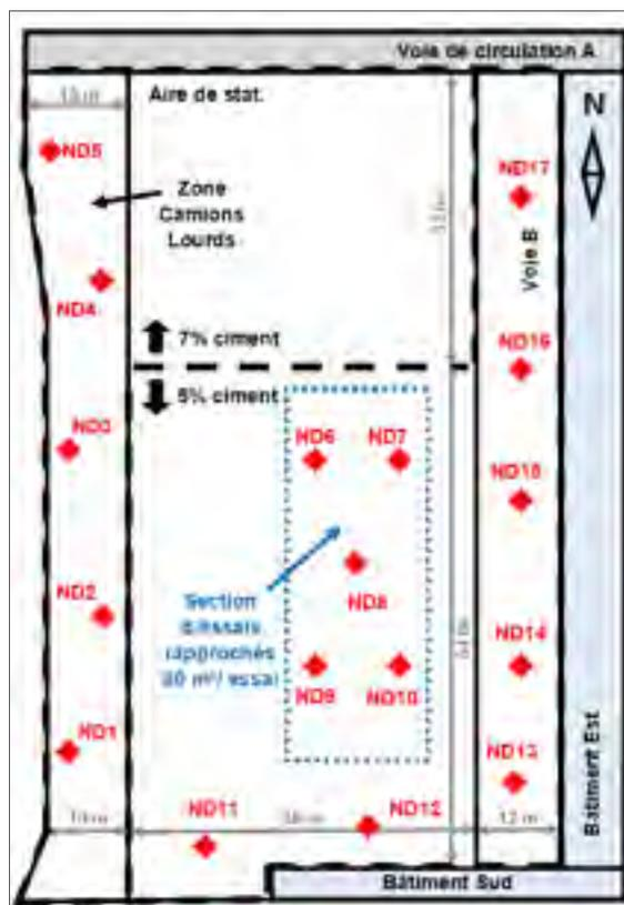
Figure 4.4 Schéma de localisation des essais au nucléodensimètre
