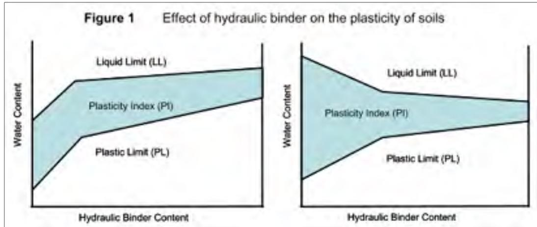
Figure 2.2 Effets d'un liant hydraulique sur la plasticité des sols
