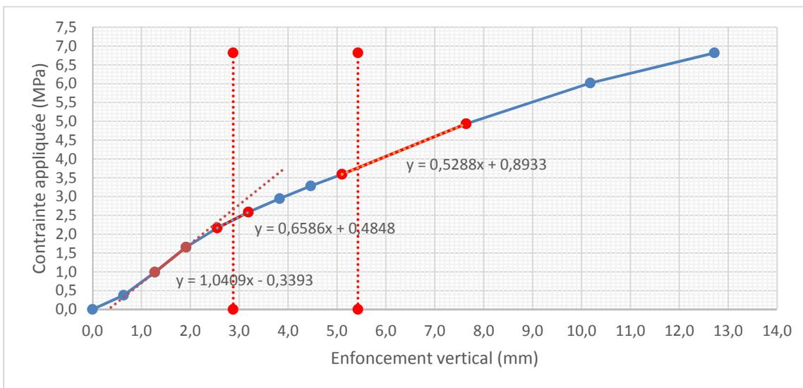
Figure 4.13 Courbe contrainte-enfoncement au CBR initial
