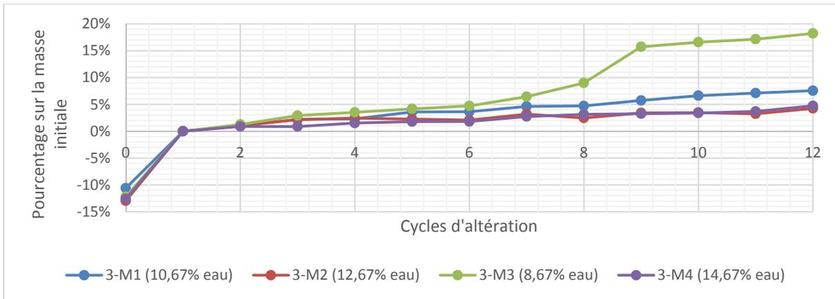
Figure 4.25 Altération au séchage-mouillage par la méthode ASTM D559 – Variation de la diminution du pourcentage de la masse moyenne par cycle - Mélanges à 3% de ciment
