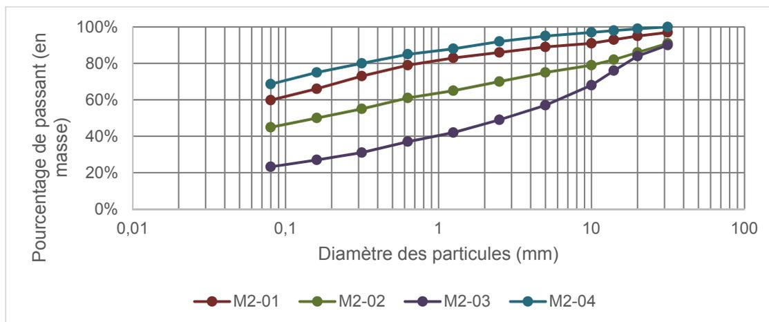
Figure 3.4 Matériau #2 - Granulométries – Remblai de sable silteux (USCS)
