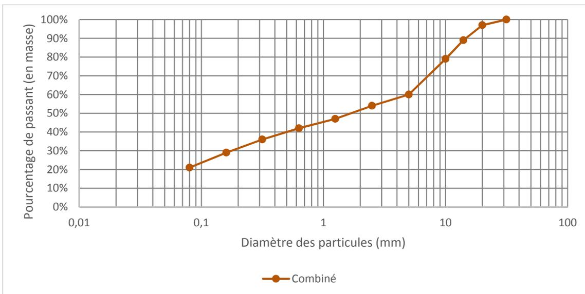
Figure 4.10 Courbe granulométrique - Matériaux #1 et #2 combinés
