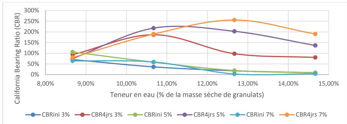
Figure 5.1 Évolution du *California Bearing Ratio* initial et à 4 jours d'immersion selon la teneur en eau – Conception à 3%, 5% et 7% de ciment
