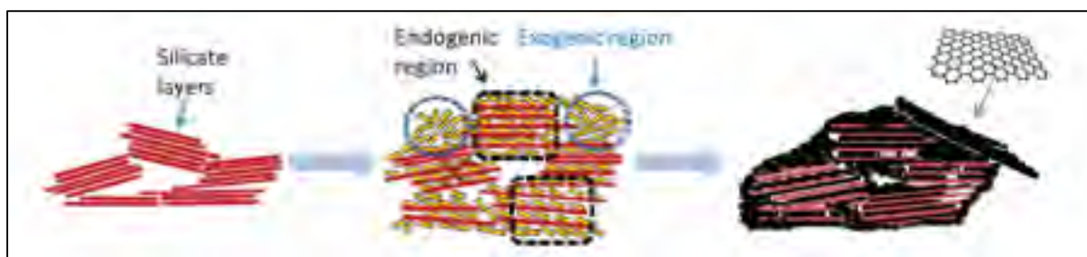
Figure 1.3 Représentation schématique des phases intermédiaires dans la production de graphène supporté par les feuillets d'argile [tirée de Ruiz-García et al. (2014)]
