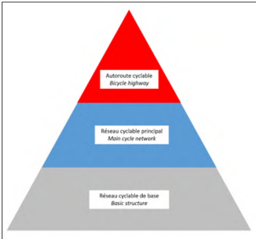
Figure 1.13 Hiérarchisation fonctionnelle du réseau cyclable néerlandais, adaptation de Centrum voor Regelgeving en Onderzoek in de Grond Water-en Wegenbouw en de Verkeerstechniek (CROW) (2016) (DMBT)
