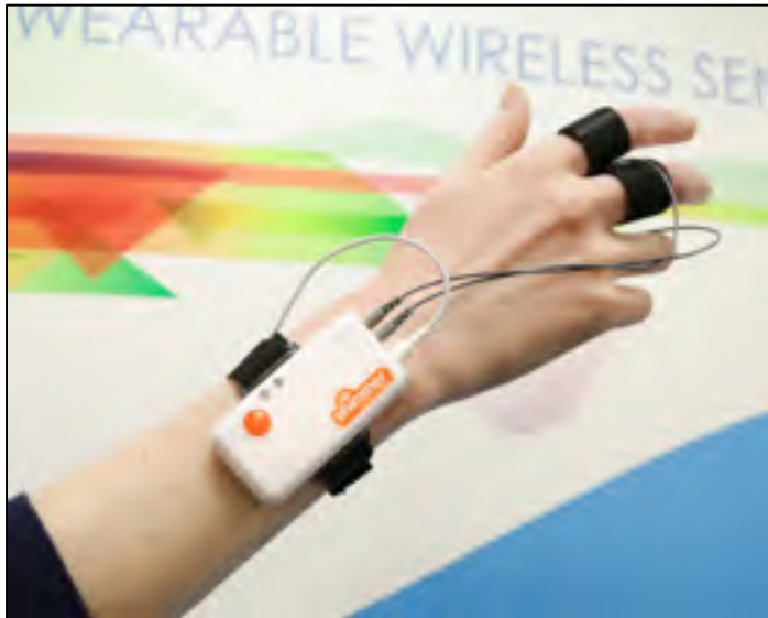
Figure 3.4 Le capteur Consensus GSR mesurant l'activité électrodermale
