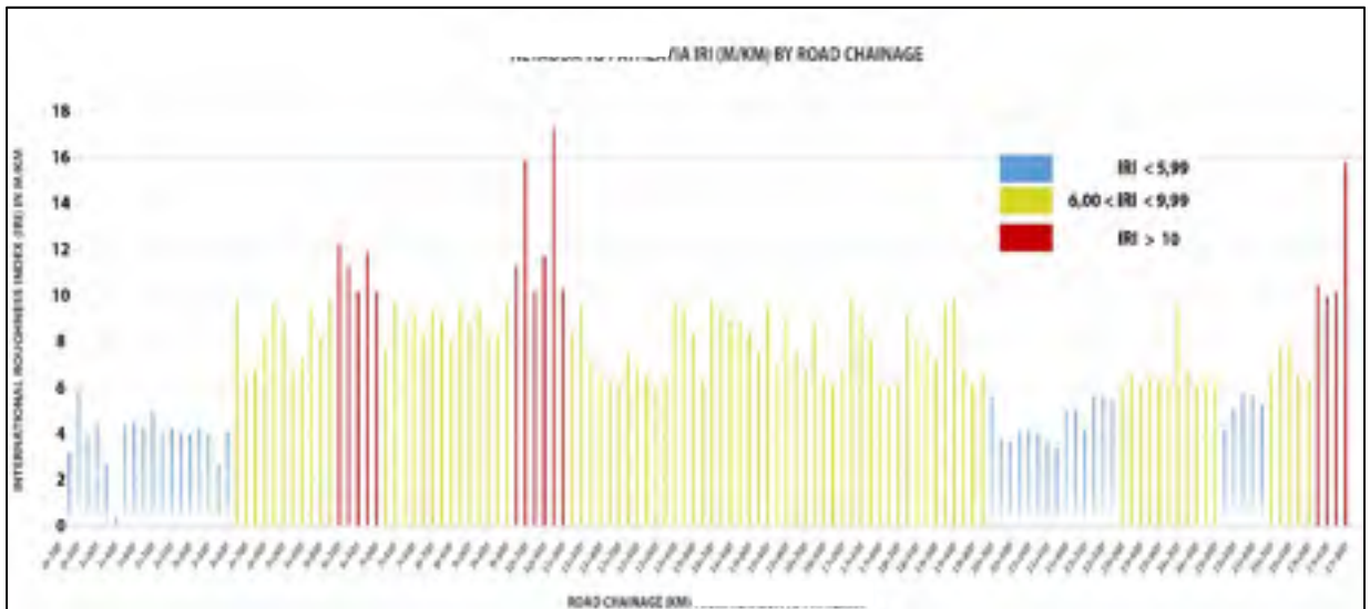
Figure 5-4 Valeur IRI en 2017 par le dispositif ARRAB Roughmeter
