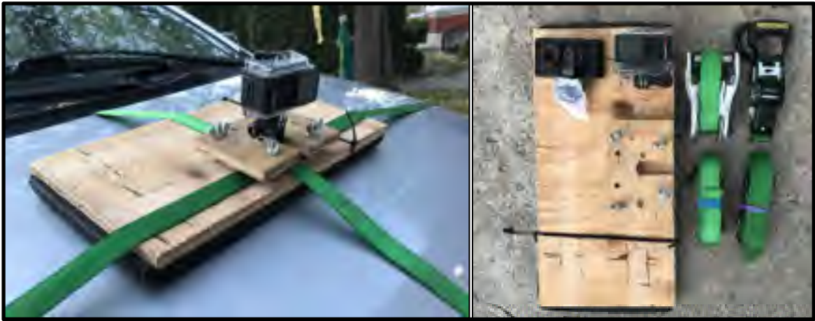
Figure 3-8 Support conçu pour fixer la caméra au capot
