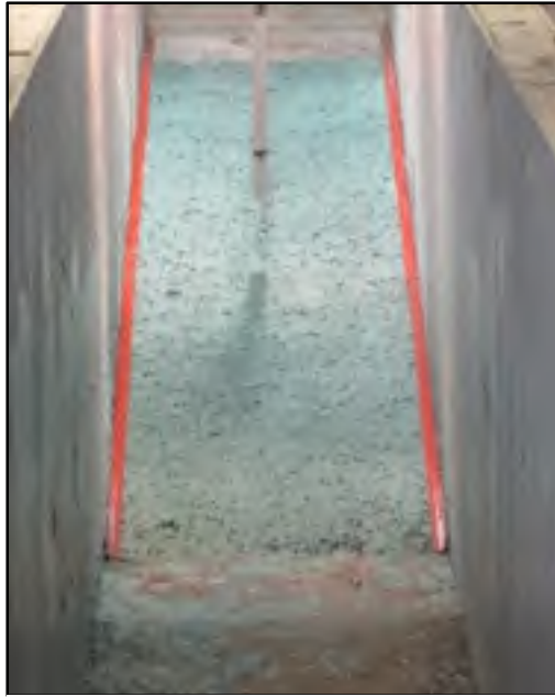
Figure 2.32 Le tapis de gazon avec la matrice de fibres Tirée de Marr et al. (2017)
