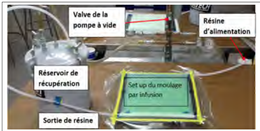
Figure 2.6 Configuration de mise en forme de l'infusion (VARTM)
