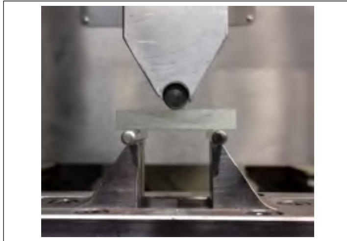
Figure 2.25 Montage d'éprouvette pour essai en cisaillement
