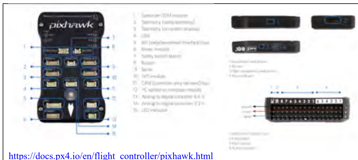
Figure 8.12 Contrôleur de vol Pixhawk embarqué sur le drone F450J
