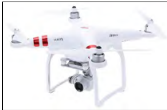
Figure 1.4 Quadricoptère Phantom 3 de la compagnie DJI
