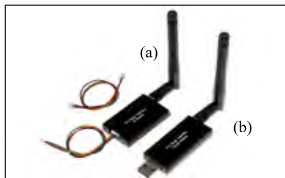
Figure 8.14 Télémétrie OSD 3DR 22 : sur le drone F450J (a) ; sur l'ordinateur (b)
