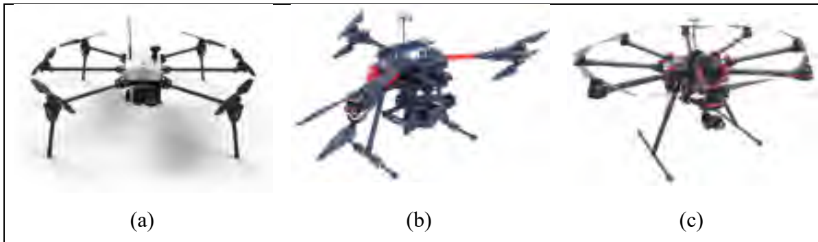
Figure 1.5 Deux configurations possibles d'hexarotors (a) - (b) et un octorotors (c)
