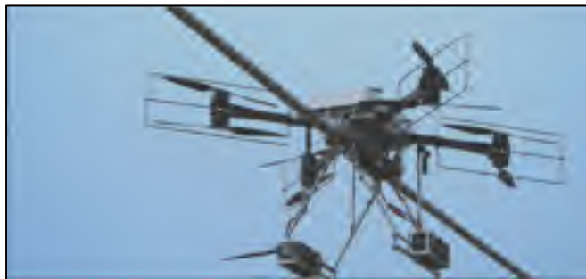
Figure 1.10 Drone inspectant une ligne électrique Tirée de Hydro-Québec (2017)
