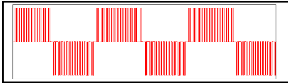
Figure 1.21 Forme d'onde de la sortie du convertisseur à deux niveaux
