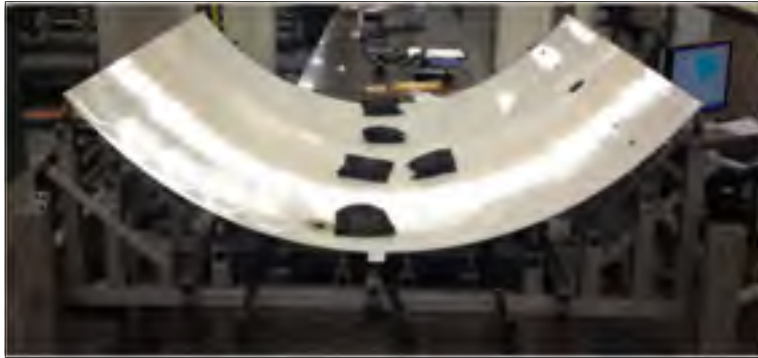
Figure 0.4 La pièce non rigide maintenue par des montages d'inspection et des charges appliquées (sacs de sable) (G. Abenham et al., 2015)
