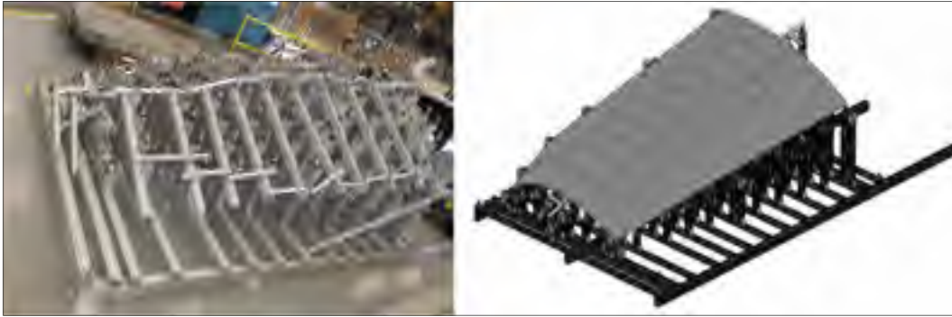
Figure 0.2 Un gabarit pour l'inspection d'un composant aérospatial non rigide, Bombardier Aerospace Inc., (Sabri, Tahan, Pham, Moreau, & Galibois, 2015).
