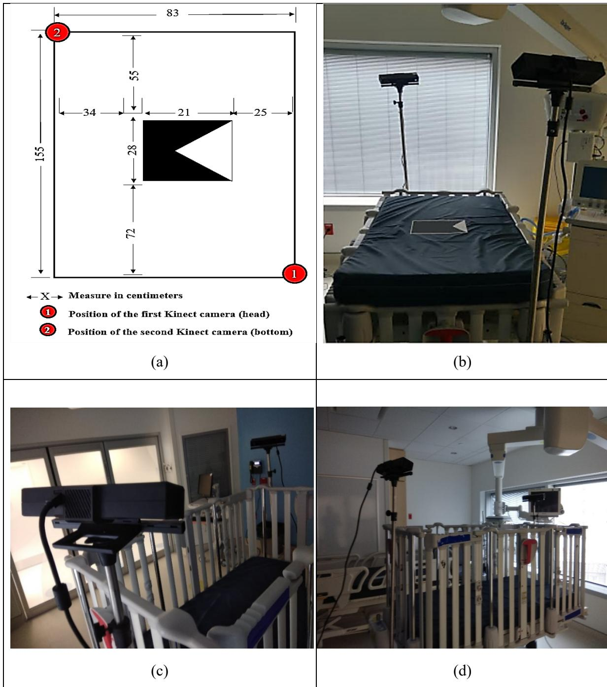
Figure B-1 Montage expérimental pour l'acquisition des données. Utilisation de deux caméras dans (b) et (c) et d'une seule caméra dans (a).
