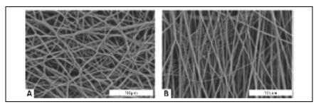
Figure 1.19 Images au MEB de fibres électrofilées de morphologie (A) aléatoire ou (B) alignée (magnification x5k) Adaptée de Whited et Rylander (2014)
