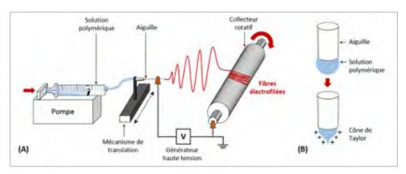
Figure 1.13 Schématisation du procédé d'électrofilage. (A) Instrumentation nécessaire pour la fabrication de fibres électrofilées. (B) Formation du cône de Taylor.
