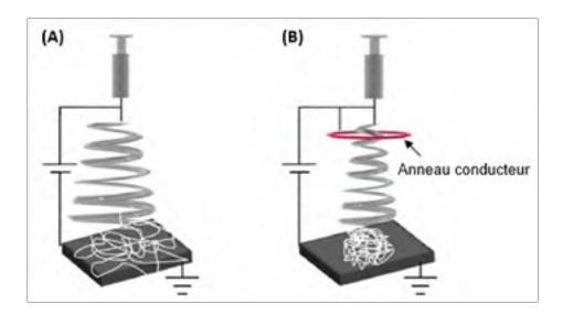
Figure 1.18 Représentation schématique de la densité de fibres déposées pour (A) un procédé d'électrofilage classique et (B) avec l'emploi d'une électrode conductrice en forme d'anneau, placée devant le collecteur Adaptée de Soliman et al. (2011)
