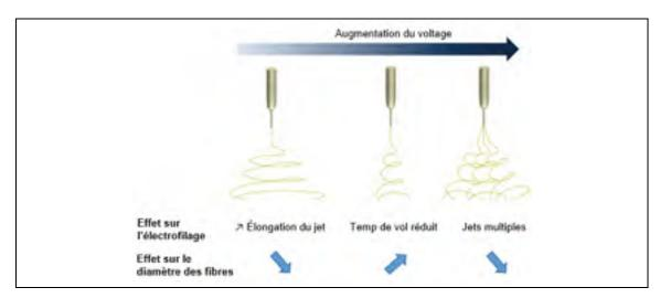
Figure 1.17 Effets de l'augmentation du voltage sur le diamètre des fibres électrofilées. Les symboles
