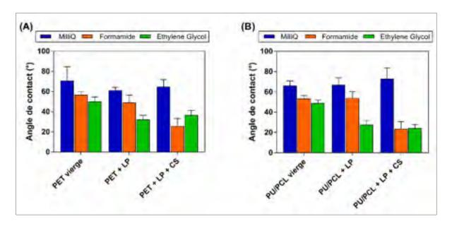
Figure-A IV-2 Angle de contact moyen pour des surfaces en (A) PET et (B) PU/PCL, dans les conditions vierges, avec dépôt L-PPE:N (LP) et revêtement CS (LP+CS)
