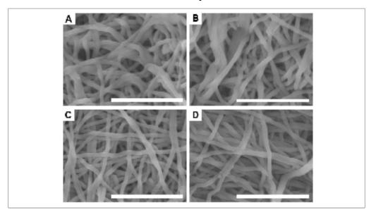
Figure-A II-1 Observation au MEB de la morphologie des fibres PU/PCL avec revêtement LP+CS pour une prothèse (A) non-stérile et (B) stérilisée à l'oxyde d'éthylène, et pour une autre prothèse (C) non-stérile et (D) stérilisée par V-PRO maX<sup>®</sup> (échelle : 10 μm).
