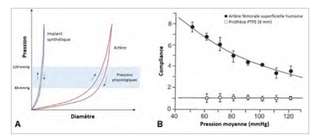
Figure 1.8 Comparaison entre une artère et une prothèse synthétique (ePTFE) de l'évolution de (A) la pression en fonction du diamètre et (B) la compliance en fonction de la pression Adaptées de (A) Singh et al. (2015) et (B) Salacinski et al. (2001)
