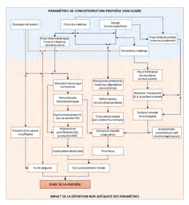
Figure 6.1 Schéma récapitulatif des principaux facteurs pouvant mener à l'échec d'une prothèse vasculaire
