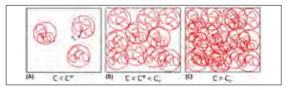
Figure 1.15 Représentation des régimes de solution. Avec R, le rayon de giration d'une chaîne de polymère ; C, la concentration de la solution ; C\*, la concentration critique de recouvrement (les chaînes commencent à se toucher) ; Ce, la concentration critique d'enchevêtrements (les chaînes s'enchevêtrent).
