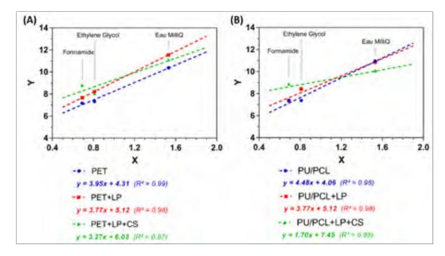
Figure-A IV-3 Régressions linéaires et équations correspondantes selon le modèle d'Owens-Wendt pour les matériaux (A) en PET et (B) en PU/PCL, dans les conditions vierges, avec dépôt L-PPE:N (LP) et revêtement CS (LP+CS). Avec x et y à partir de l'équation (A IV-3).
